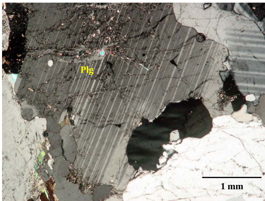
Foto 18: Grão de plagioclásio subédrico com núcleo alterado. Polarizados cruzados. Lâmina PT-DD-4-C.
