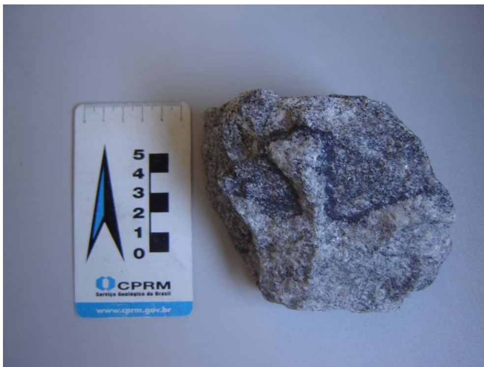
Foto 12: Amostra PT-DD-04-D selecionada para geoquímica. O veio foi retirado para a preparação da amostra.
