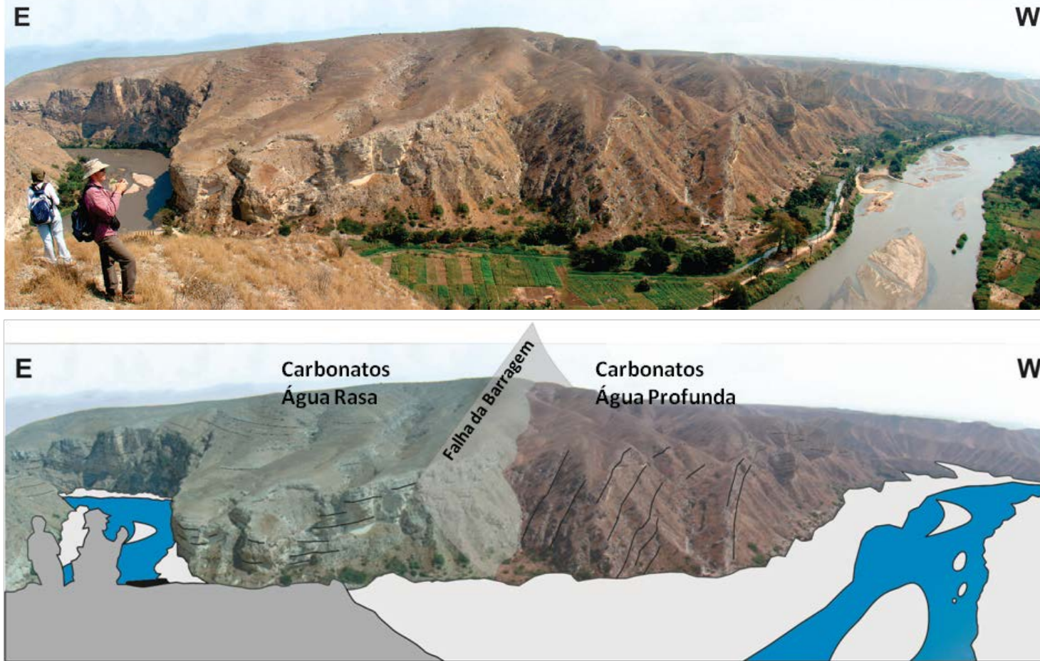
Figura 48 - Fotomosaico da margem sul do Rio Catumbela, onde se encontra a Falha da Barragem. Em campo, se observa que essa falha promove o contato entre os carbonatos de água rasa da unidade inferior (Formação Catumbela) com os carbonatos de águas mais profundas da unidade superior (Formação Quissonde).
