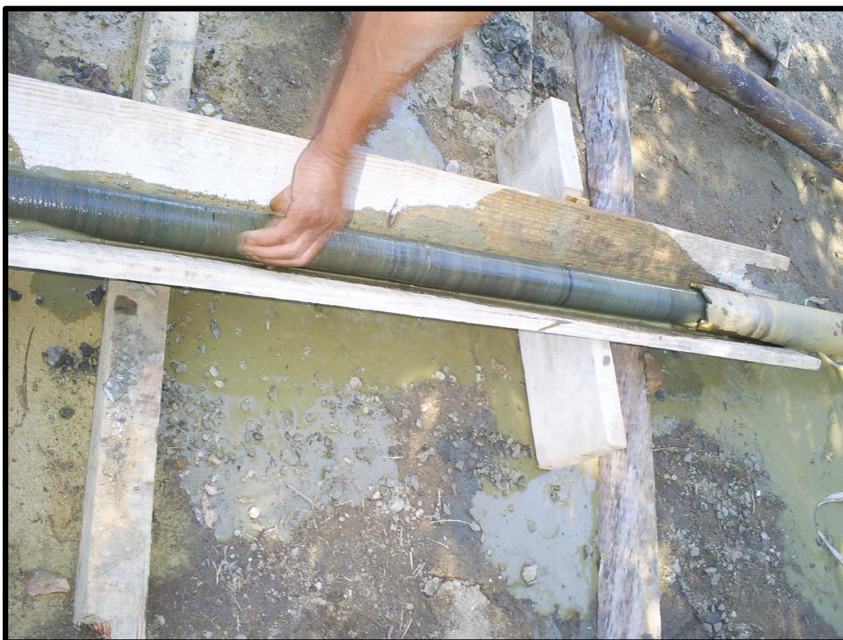
Figura 13 - Retirada de testemunho no poço MOR-1-SP. Fonte: CREMONINI, 2012.
