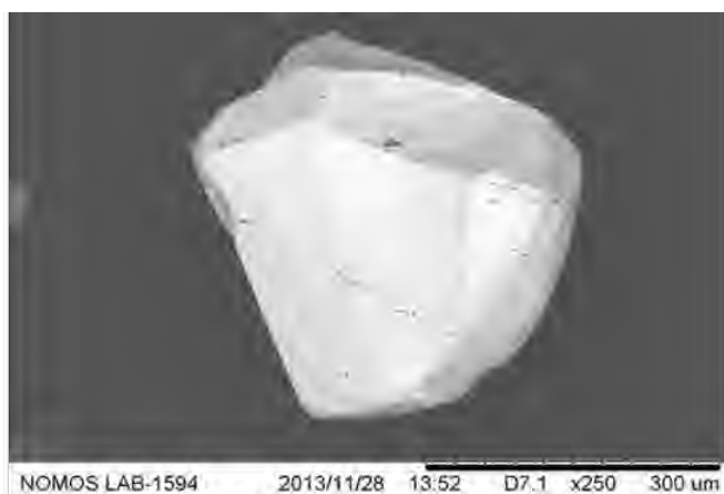
Figura 51 – Imagem em MEV de grão de scheelita com aproximadamente 400 µm e composição elementar
