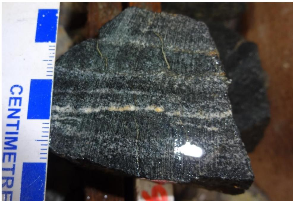
Legenda: Bandas mais ou menos ricas em plagioclásio (furo CG-SB-DDH-0001, profundidade 15,05 m). Diâmetro do testemunho é de 63,5 mm.
