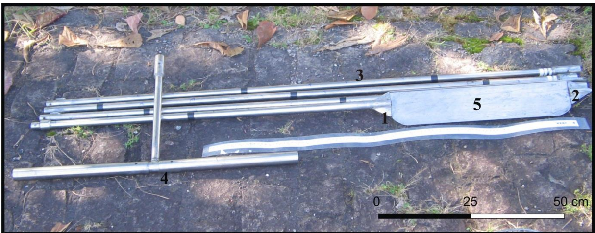
Figura 31 - Componentes do trado russo, que são acondicionados em estojo de madeira (1: tubo amostrador; 2:ponteira; 3: barras de extensão; 4: manivela; 5: chapa de alumínio).
