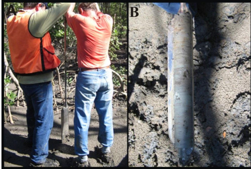
Figura 32 - Estágios de testemunhagem. A) Penetração do testemunhador no substrato; B) Seção sedimentar recém-amostrada (com 50 cm).
