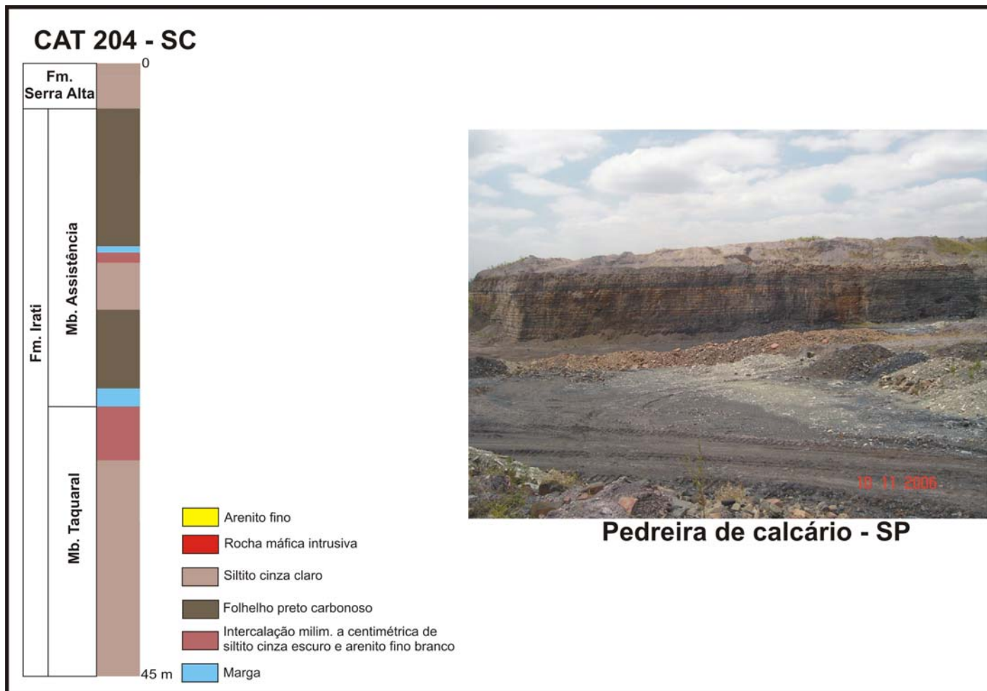
Fig. 7.44 – Fm. Irati no poço CAT 204 (sem as intrusivas) em Lauro Müller – SC e numa pedreira de calcário no estado de SP.
