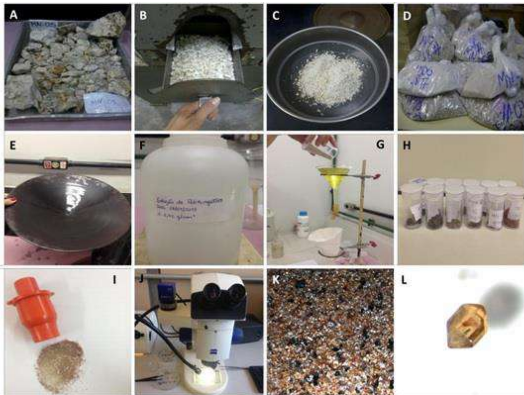
Figura 3- Fotos com as etapas de preparação das amostras brutas para determinação dos minerais em lupa
