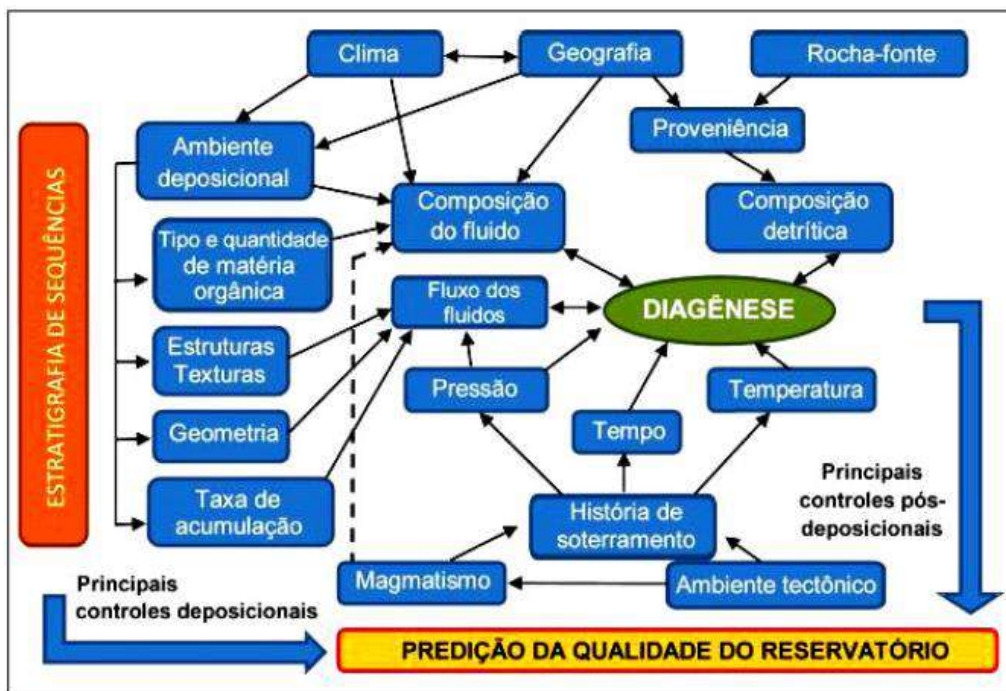
Figura 20 - Fluxograma mostrando as relações entre os parâmetros controladores da diagênese para rochas siliciclásticas.
