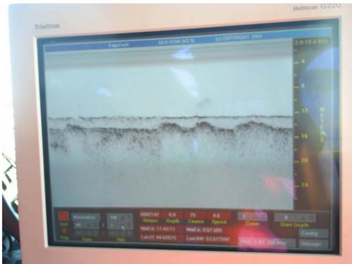
Foto 13: Exemplo de registro sísmico em tempo real no monitor de bordo.
