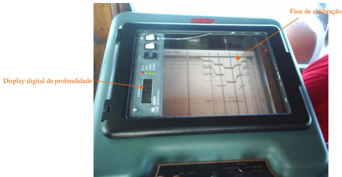
Foto 11: Ecobatímetro Raytheon (durante a fase de calibração).
