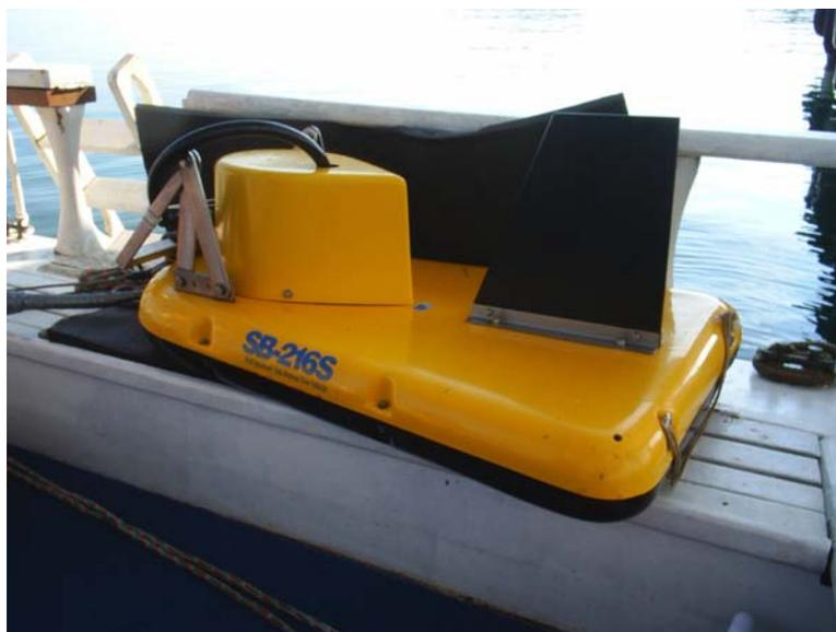
Foto 9: Perfilador de subfundo Geostar SB-216 S (Raia).
