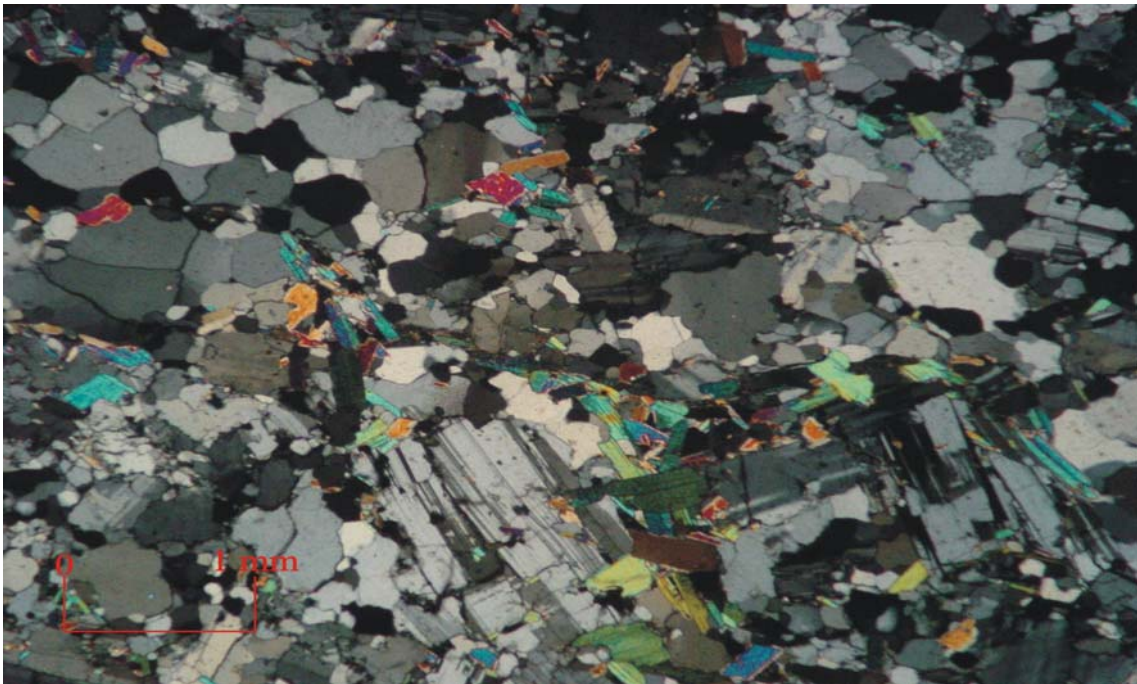
Fotomicrografia 6.4. Granodiorito Primavera, amostra BO-04-20 de granulometria média à fina, com quartzo, plagioclásios com muscovita tabular sobreposta sobre os minerais félsicos, sugerindo origem secundária, objetiva 2.5 x, nicóis (X).
