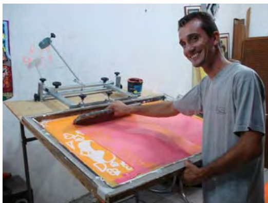
Ilustração 50 – O componente Alan, do Grupo Enigma, serigrafava casacas, forros de sombrinha e tecidos de macacões num ateliê improvisado no quintal de casa, em Marechal Hermes. Na fotografia, Alan imprime no tecido das costas de uma casaca de sua turma o contorno do desenho final, utilizando tinta rosa (Acervo da autora).
