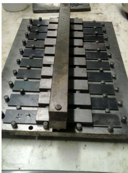
Figura 39 – Posicionamento das barras de apoio e contrapesos no gabarito
