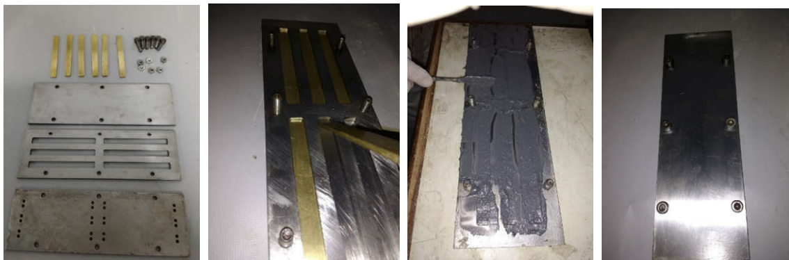
Figura 42 – Etapa de produção de CPs para ensaio de DMA
