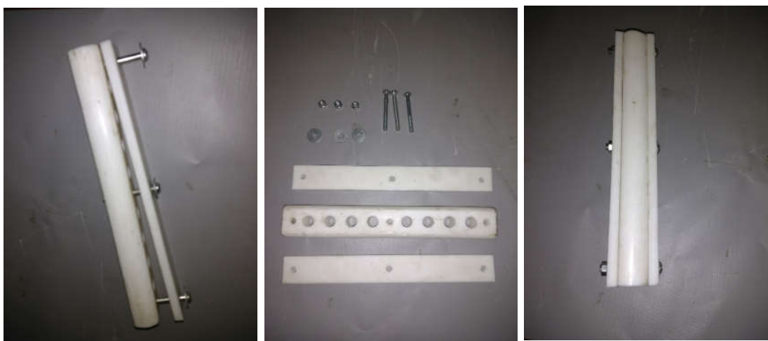
Figura 24 – Molde de teflon para corpos de prova de ensaio de compressão
