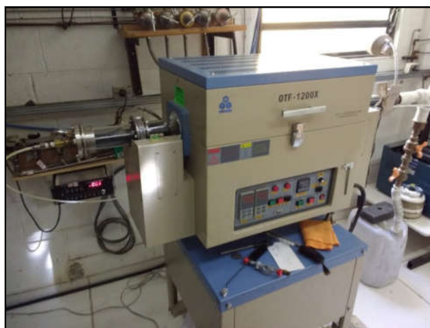
Figura 21 – Forno de deposição química por vapor (CVD) para produção de NTC e grafeno
