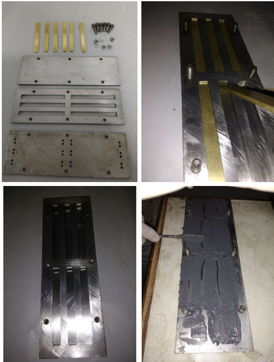
Figura 26 – Etapas de produção de corpos de prova para ensaio de flexão
