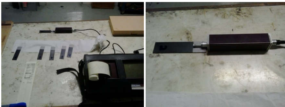
Figura 33 – Avaliação da rugosidade das chapas com rugosímetro portátil
