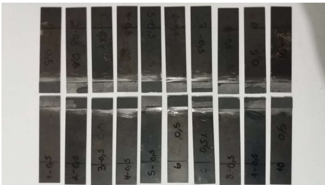
Figura 55 – Juntas metálicas coladas com adesivo NVT-201E lote 2/0,5% grafeno
