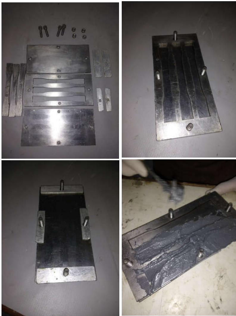
Figura 28 – Etapas de produção de corpos de prova para ensaio de tração
