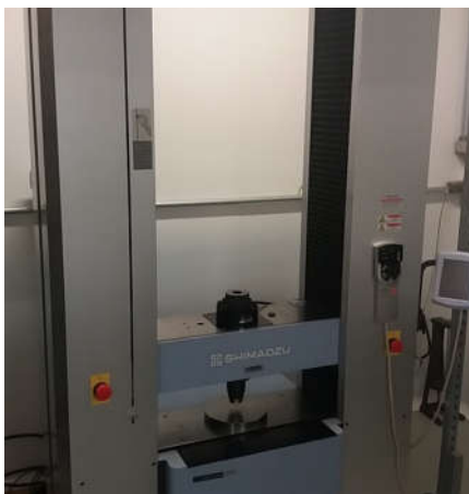
Figura 23 – Máquina universal de ensaios mecânicos SHIMADZU AG-X plus.
