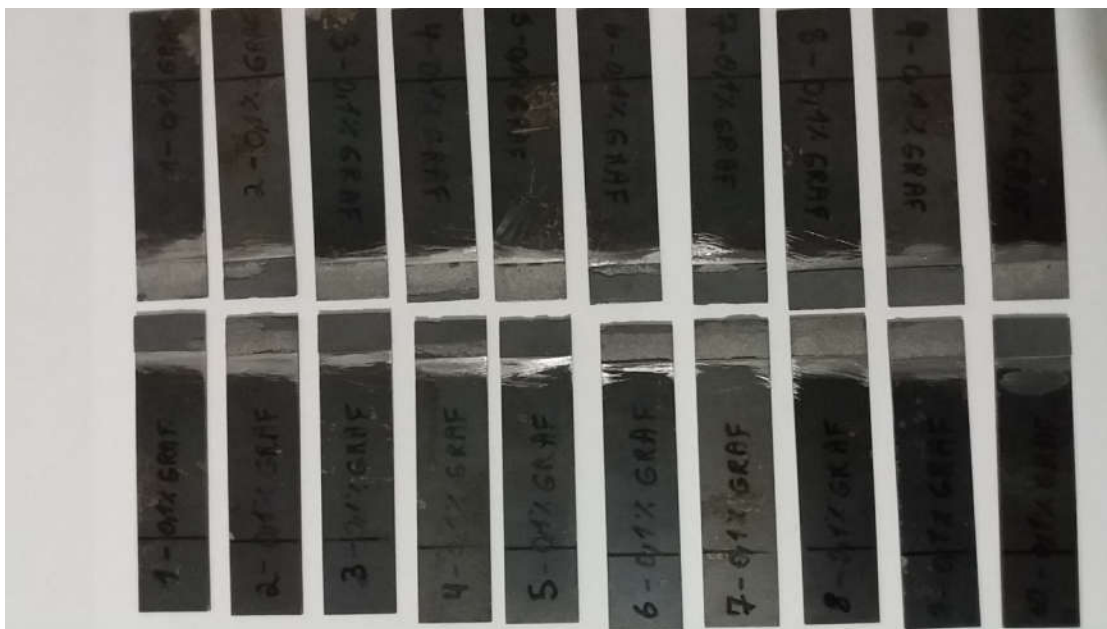
Figura 54 – Juntas metálicas coladas com adesivo NVT 201 E lote 2/0,1% grafeno
