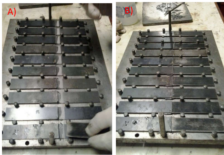
Figura 38 – Remoção do excesso de adesivo e posicionamento dos batentes superiores
