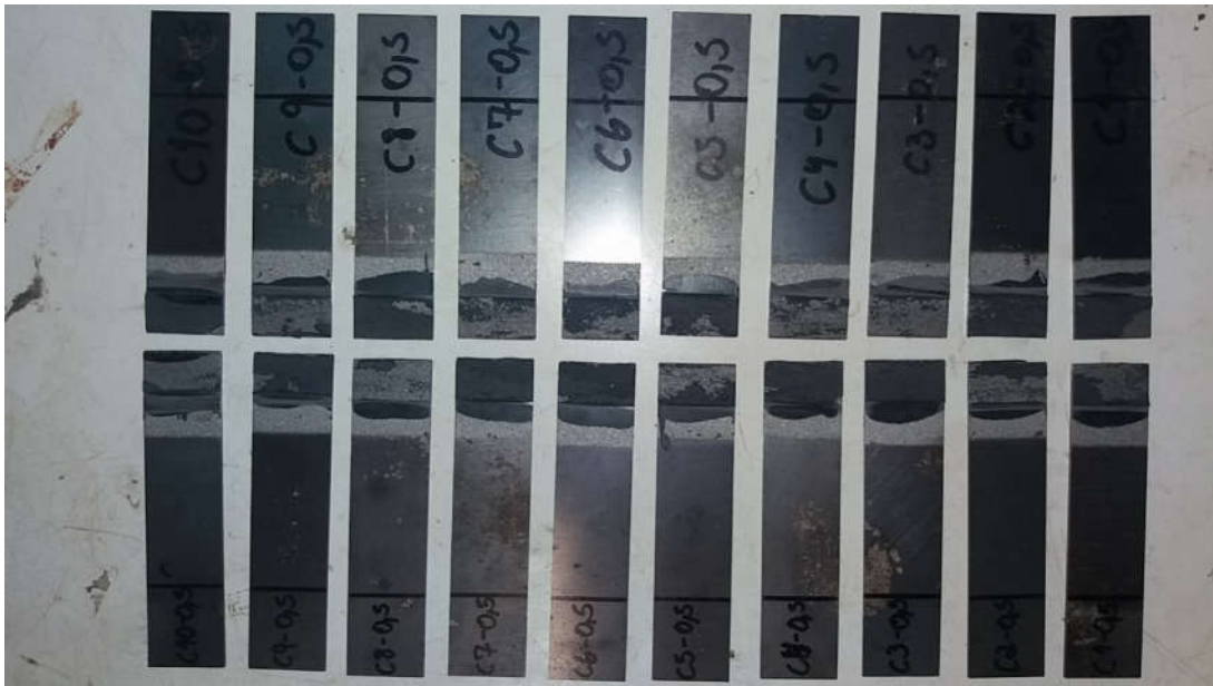
Figura 52 – Juntas metálicas coladas com adesivo NVT 201E lote 1/0,5% NTC
