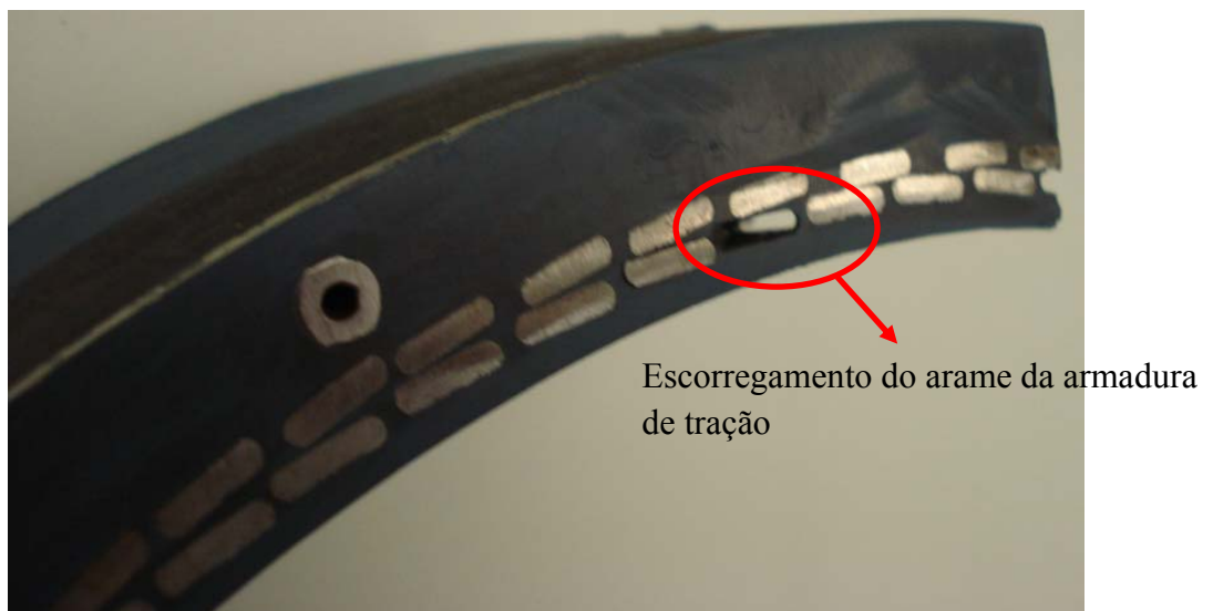
Figura 3.6: Vista inferior do final do dobramento dos ganchos
