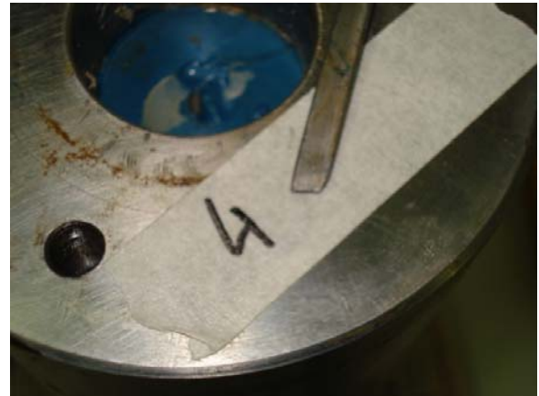
d) Ruptura fora do bloco de resina, cp 4
