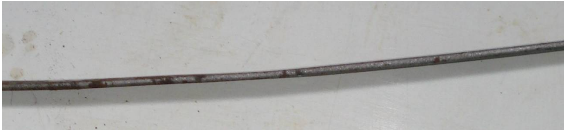
Figura 5.2: Arame da armadura de tração após desfazimento da hélice
