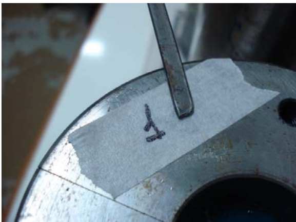
a) Ruptura fora do bloco de resina, cp 1
