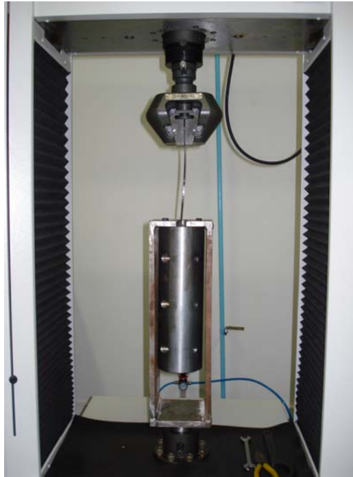
Figura 4.9: Ensaio de arrancamento na máquina de tração
