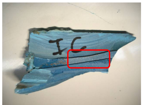
d) Arrancamento da resina epóxi
