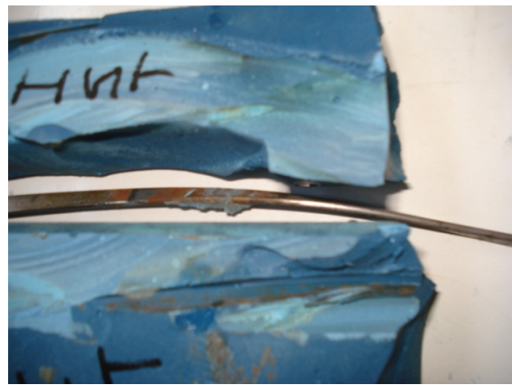
d) Ruptura adesiva
