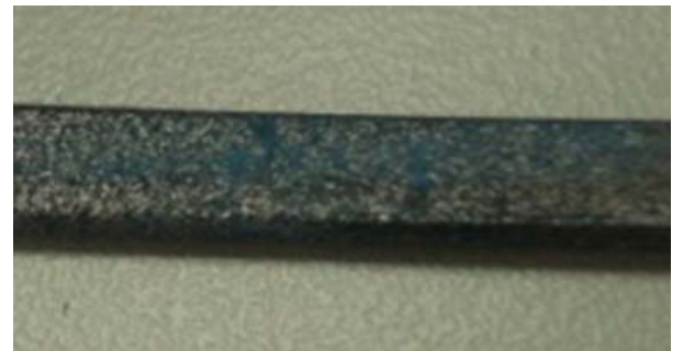
c) Resina epóxi aderida ao arame
