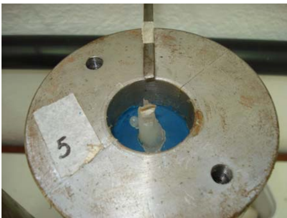
e) Ruptura fora do bloco de resina, cp 5
