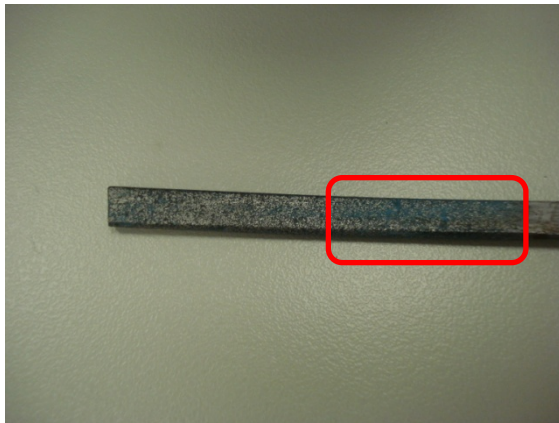
c) Resina epóxi aderida ao arame
