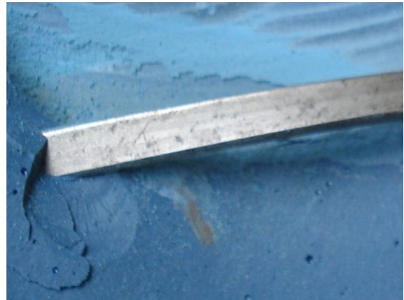
b) Ruptura adesiva
