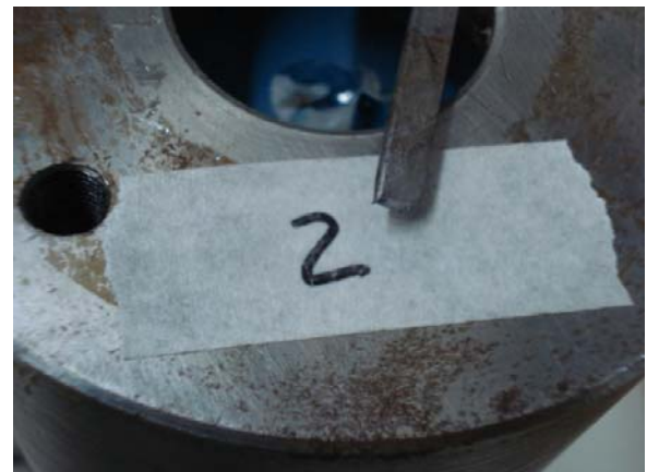
b) Ruptura fora do bloco de resina, cp 2
