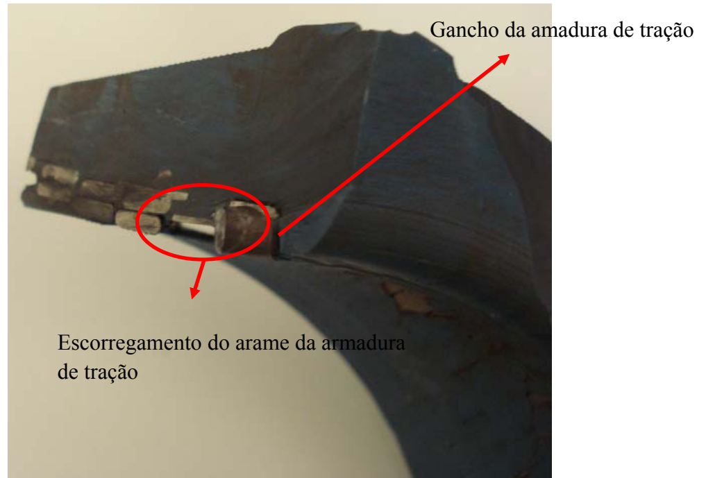
Figura 3.7: Vista superior do final do dobramento dos ganchos
