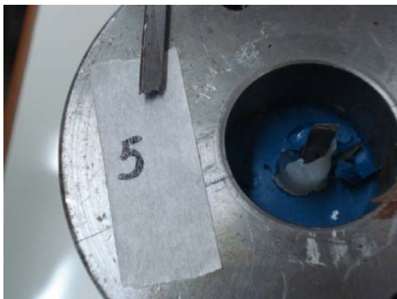
e) Ruptura fora do bloco de resina, cp 5
