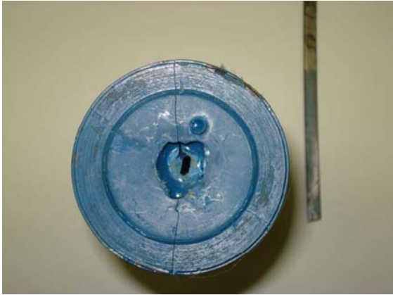
a) Deslizamento do arame sobre a resina
