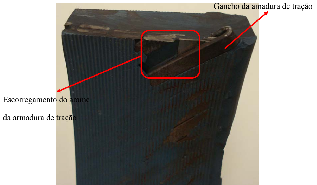
Figura 3.8: Vista interna do final do dobramento dos ganchos
