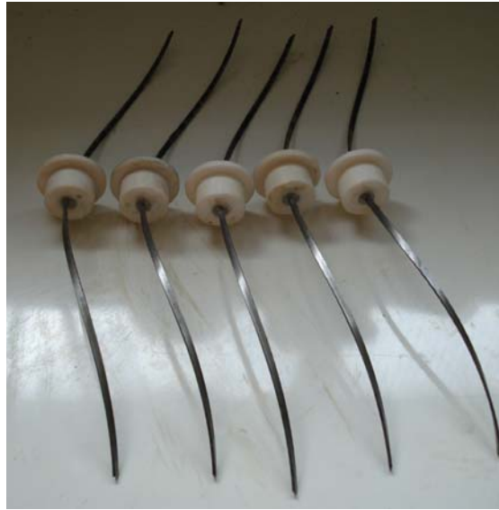
Figura 5.5: Preparação dos arames com a profundidade de 200 mm
