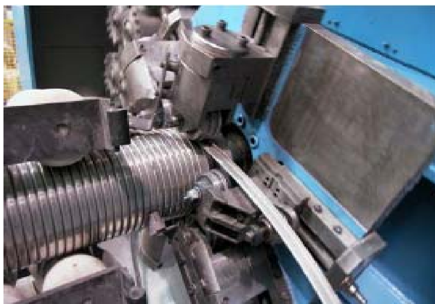
Figura 2.4: Assentamento da camada carcaça intertravada (Petrobras)
