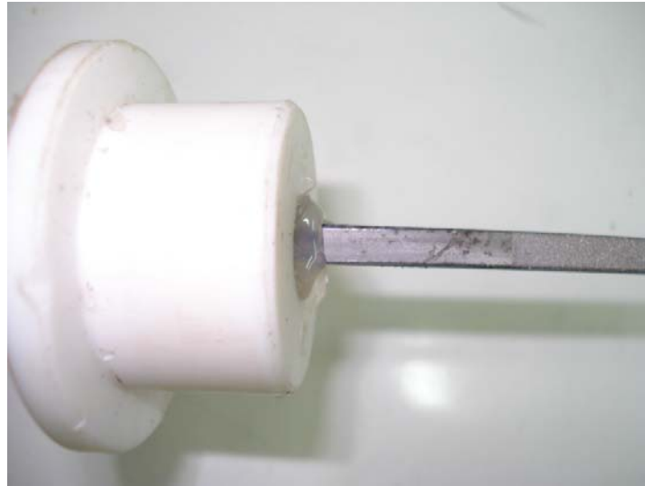
Figura 5.10: Perfil com rugosidade e desmoldante
