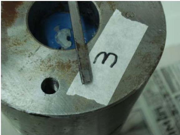
c) Ruptura fora do bloco de resina, cp 3
