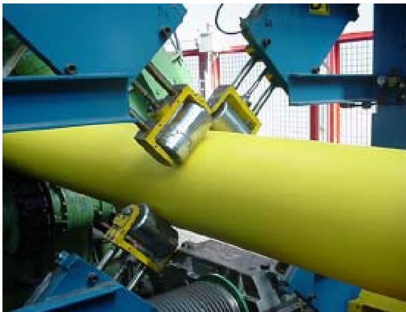
Figura 2.9: Final da extrusão da capa externa (Petrobras)
