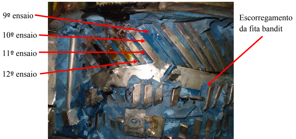
Figura 6.19: Escorregamento da fita bandit
