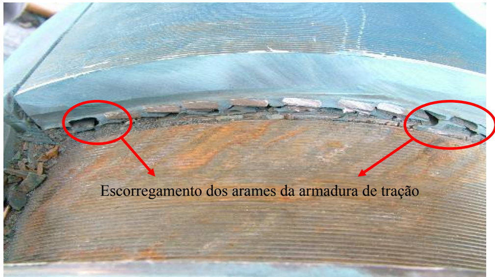
Figura 3.5: Escorregamento dos arames dentro da resina epóxi (Petrobras)
