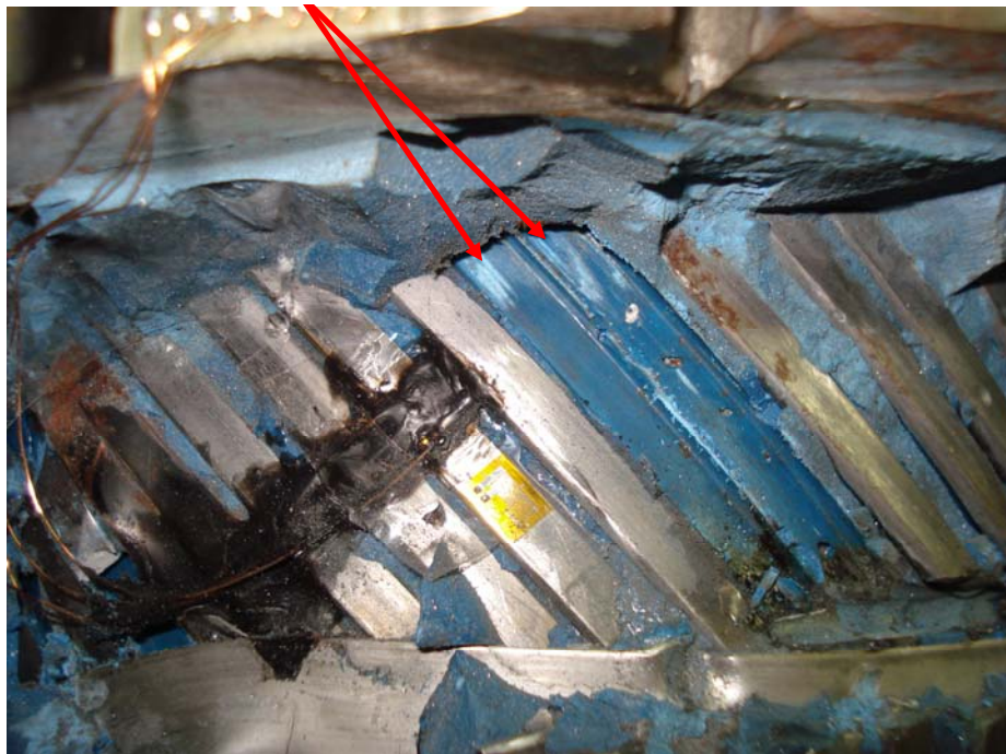
Figura 6.12: Abrasão na resina
