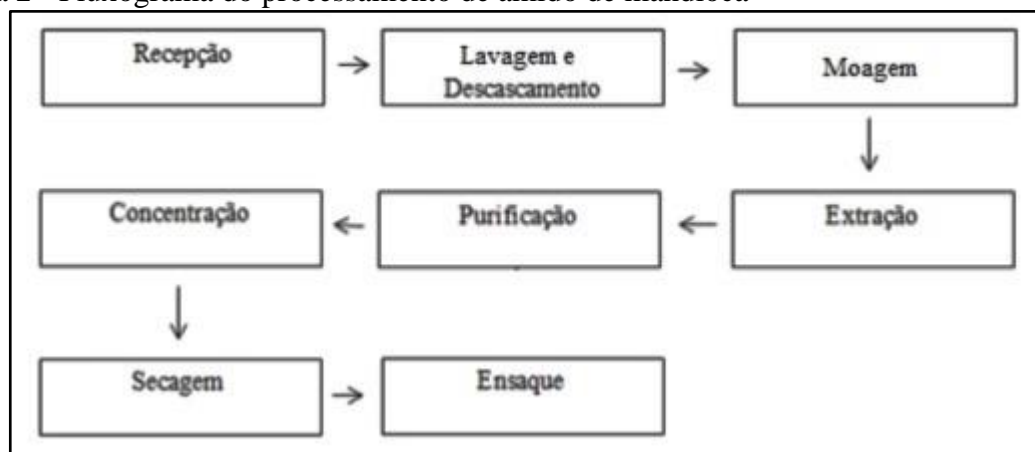
Figura 2 - Fluxograma do processamento de amido de mandioca
