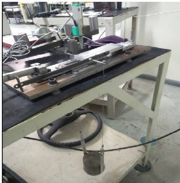
Figura 17 - Suporte para peso do equipamento de simulação de desgaste desenvolvido pela empresa NFP Automotive
