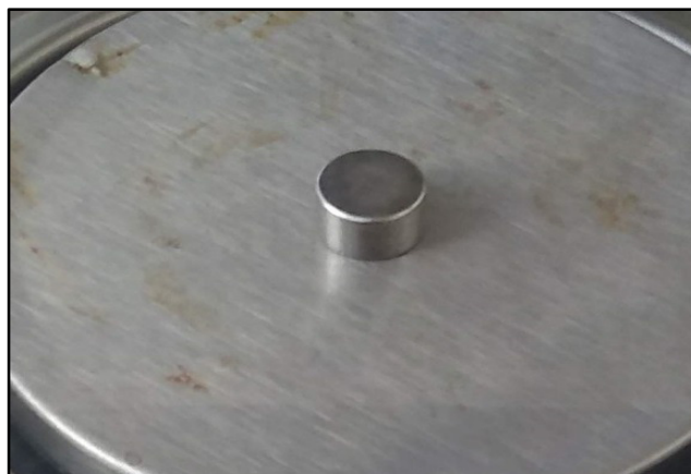
Figura 15 - Contracorpo metálico utilizado no teste de simulação de desgaste
