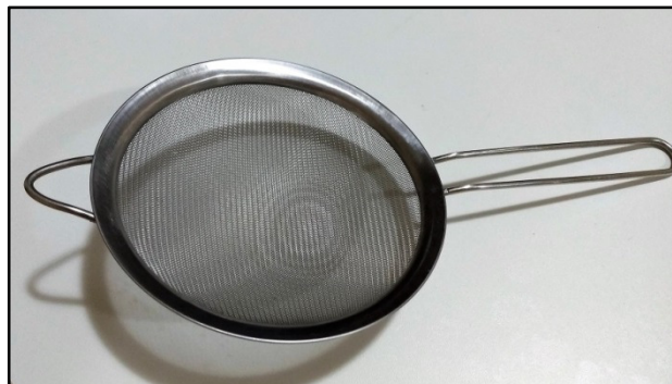
Figura 11 - Peneira de cozinha utilizada para pré-selecionar o pó da PA11 reciclada
