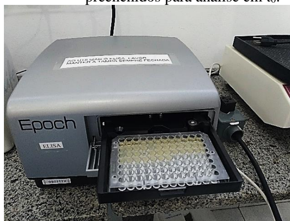
Figura 26 – Espectrômetro e placa com poços preenchidos para análise em t_0 .
