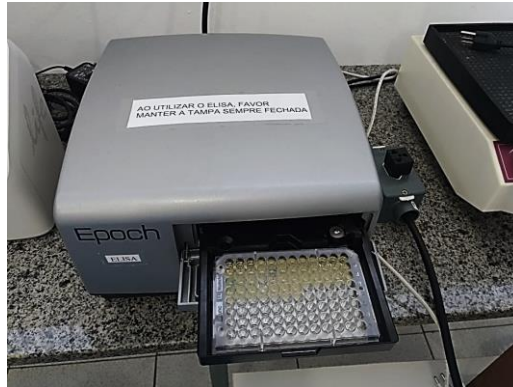
Figura 28 – Espectrômetro e placa para análise em t 24 .
