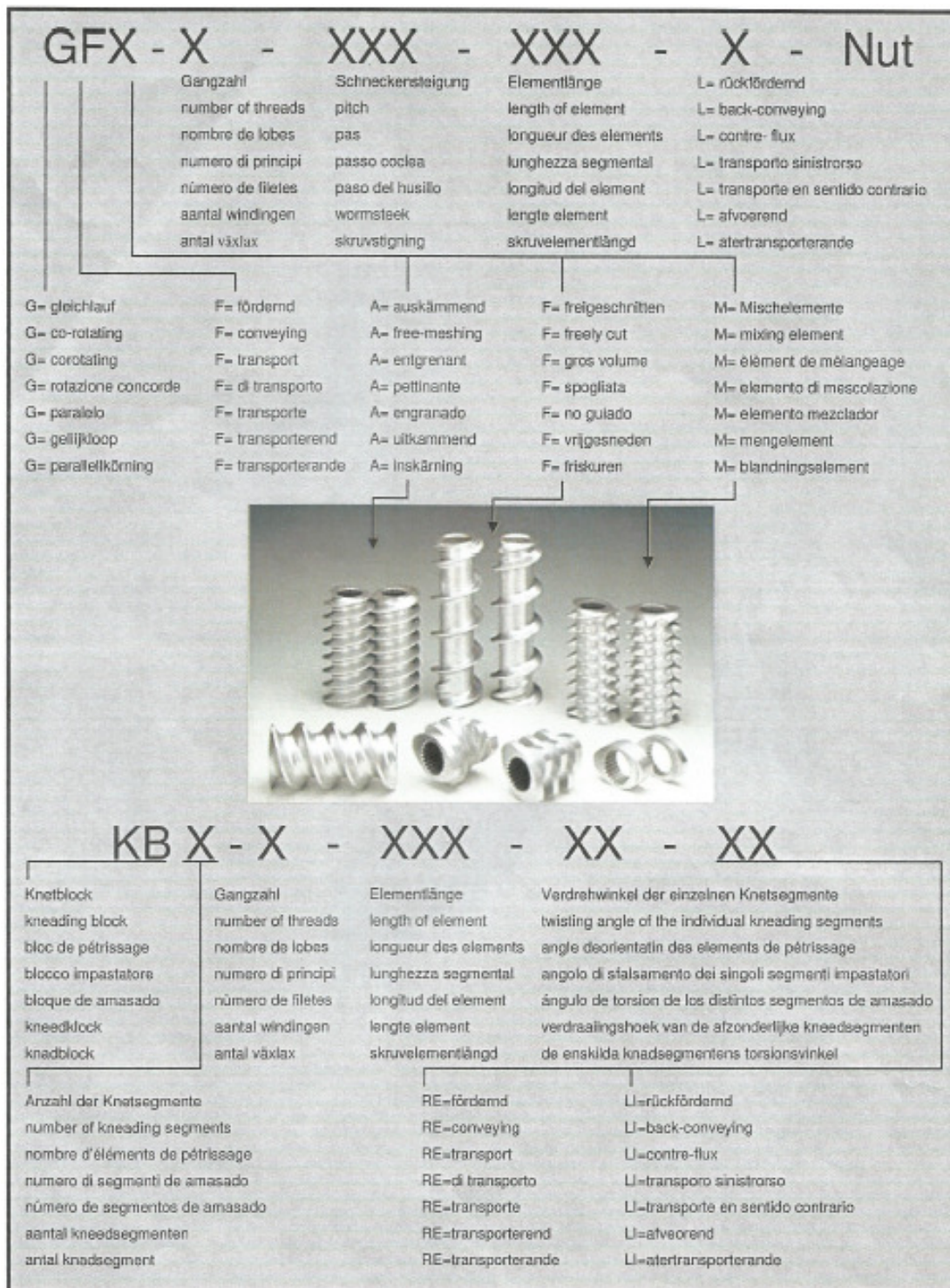
Figura 32 - Designação dos elementos do parafuso da extrusora de rosca dupla
