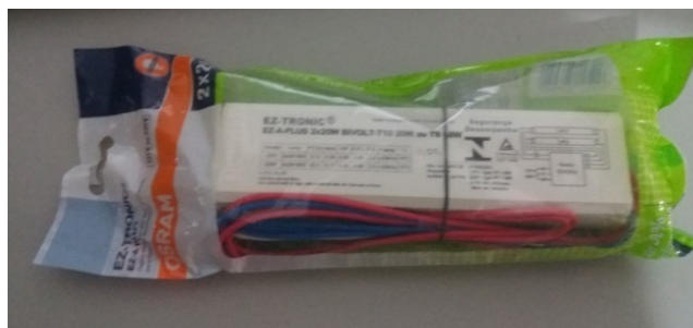
Figura 15 - Reator EZ-TRONIC® utilizado nesta Dissertação para a montagem da câmara experimental de UV
