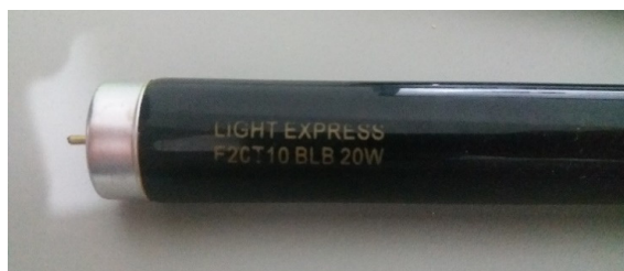
Figura 14 - Lâmpada fluorescente UVA selecionada nesta Dissertação para os estudos de envelhecimento acelerado através de exposição à radiação UV
