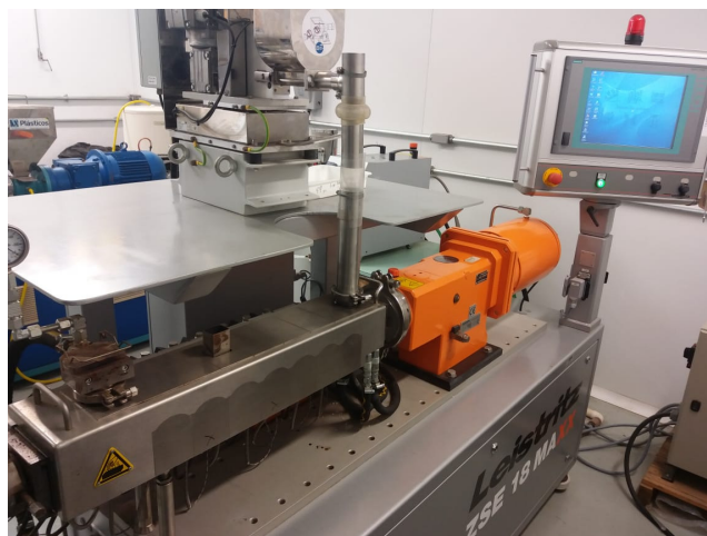
Figura 11 - Extrusora de dupla rosca da marca Leistritz®, modelo ZSE 18 Maxx, localizada no Laboratório de Tecnologia de Polímeros (TECPOL), Instituto Politécnico (IPRJ / UERJ), Nova Friburgo, RJ
