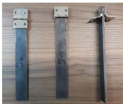
Figura 56 – Representação dos corpos de prova colados
