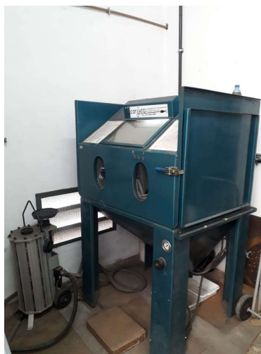
Figura 42 – Máquina de jateamento com granalha de aço
