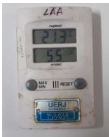
Figura 59 – Representação do termohigrômetro utilizado no ensaio
