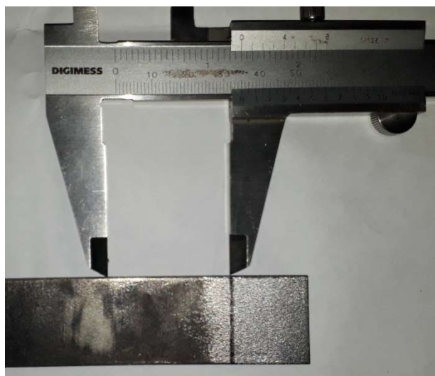
Figura 54 – Medição para posicionamento das dobradiças
