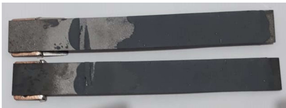
Figura 68 – Representação do corpo de prova após ensaio MMB
