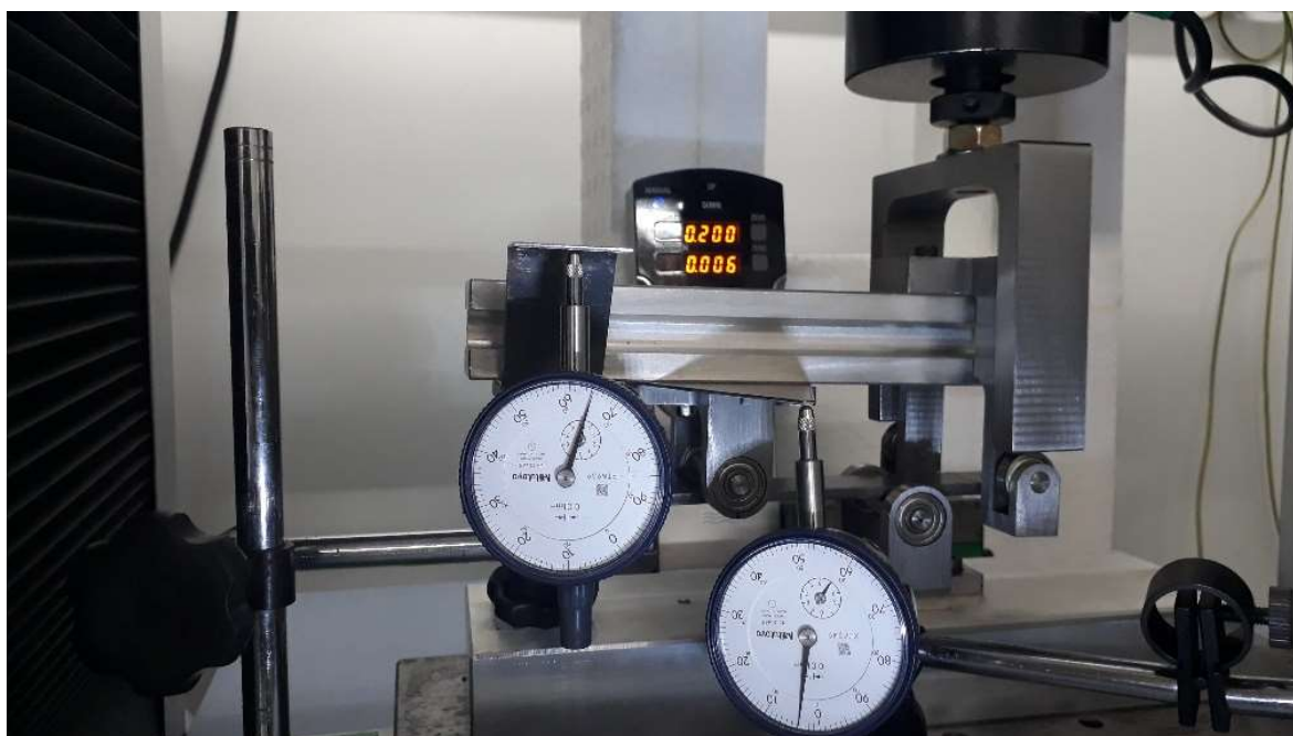
Figura 58 – Representação do posicionamento dos relógios comparadores
