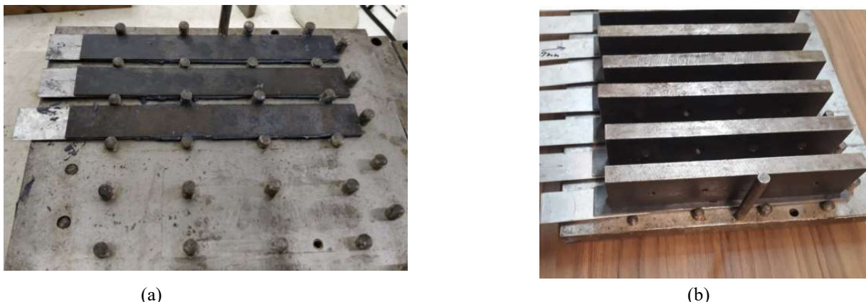
Figura 50 – Posicionamento dos corpos de prova nos moldes
