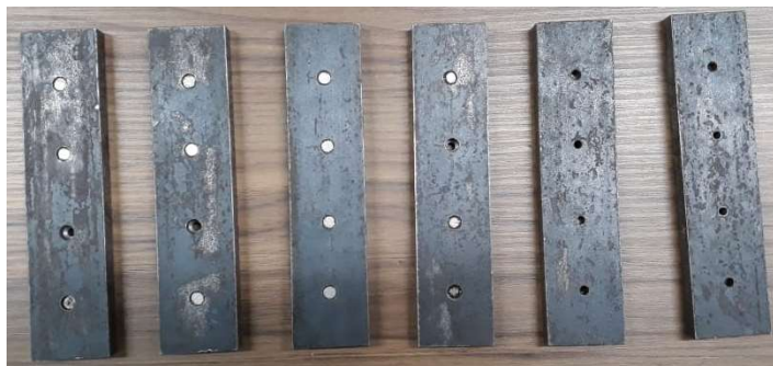
Figura 47 – Placas de apoio para aplicação de peso nos corpos de prova após a colagem
