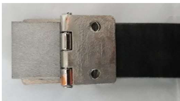
Figura 55 – Posicionamento de dobradiças nos substratos
