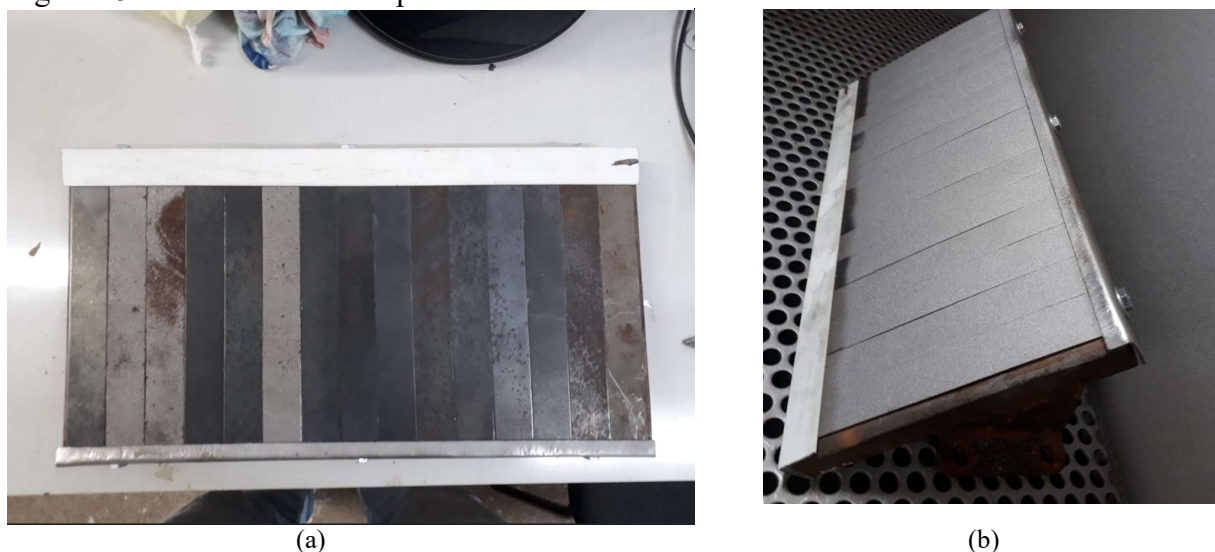
Figura 43 – Jateamento do corpo dos substratos
