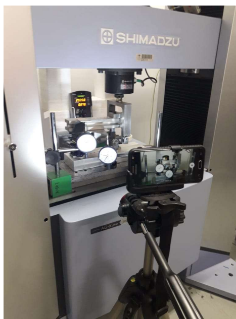
Figura 57 – Representação do ensaio MMB
