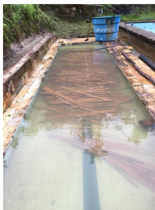
Figura 33 - Tratamento dos bambus pelo método de imersão prolongada
