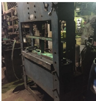
Figura 36 - Prensa utilizada na prensagem dos compósitos estruturais de bambu
