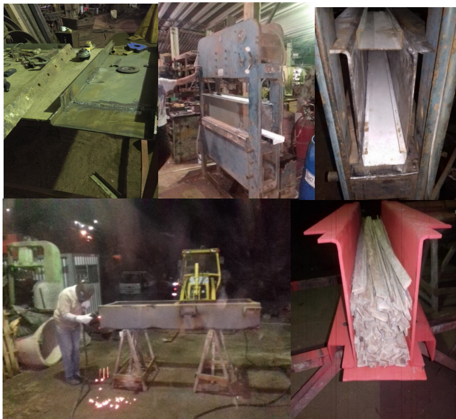
Figura 37 – Fabricação do molde para prensagem a partir de chassi de caminhão
