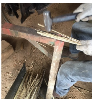
Figura 42 - Ripas com espessuras menores sendo marteladas contra o metal.
