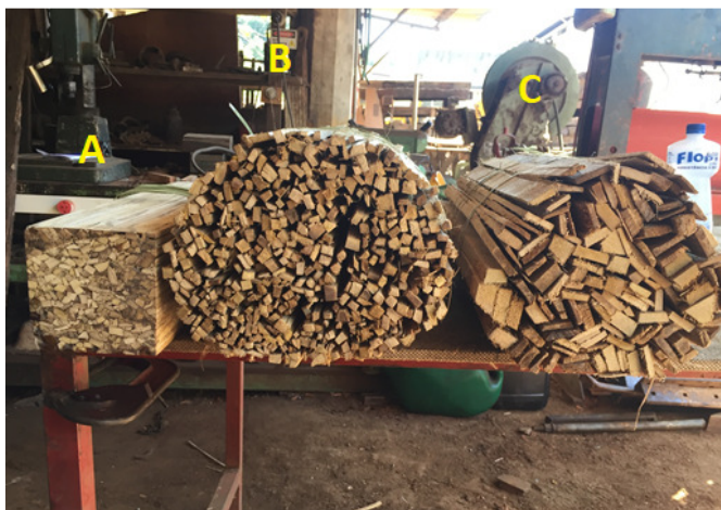
Figura 41 - Diminuição dos tamanhos das fibras até peça prensada C > A.
