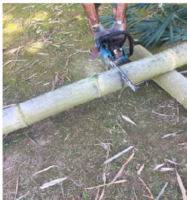
Figura 29 - Divisão dos colmos de bambu em comprimento de 1,5m com auxílio de motosserra.
