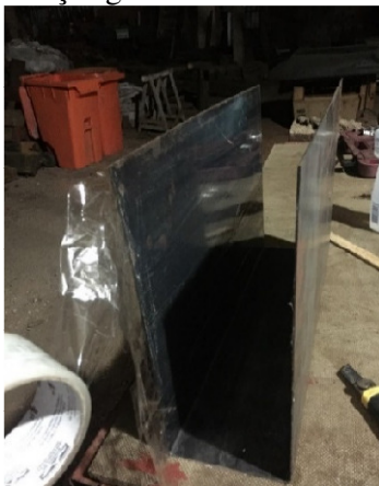
Figura 47 - Molde de aço galvanizado flexível revestido com fita plástica.
