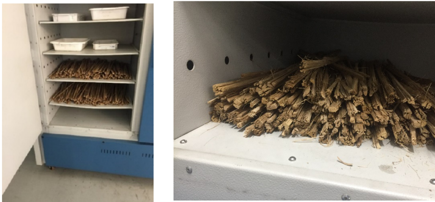
Figura 43 - Secagem das ripas antes da prensagem.
