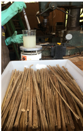
Figura 46 - Aquecimento da resina antes da prensagem.
