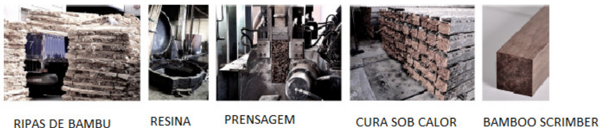
Figura 25 - Processo geral de manufatura do bamboo scrimber na China
