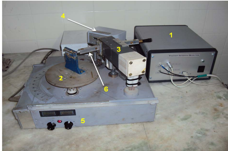
Figura 4.3: Difratômetro de Raios X(1 Unidade Eletrônica, 2 Goniômetro e suporte da amostra, 3 Ampola de raios X, 4 Detector, 5 Fonte para a alta tensão, 6 Colimador)
