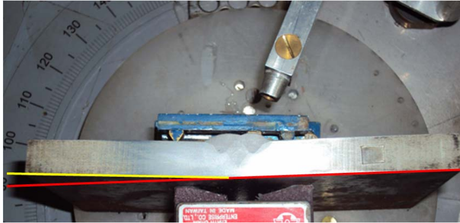
Figura 5.2: Deformação angular ocorrida após o processo de soldagem MIG.
