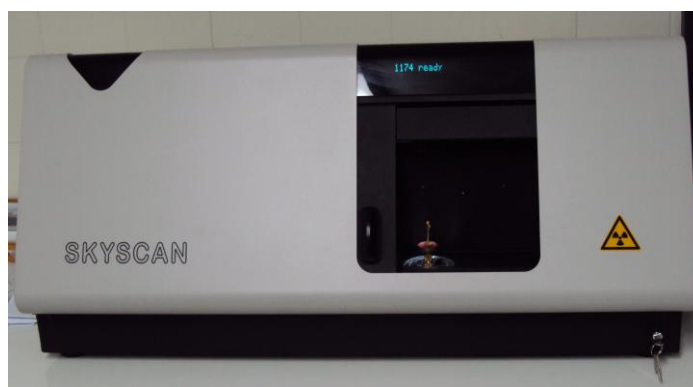
Figura 24 - Microtomógrafo da Skyscan (Modelo 1174) portando uma amostra óssea Fonte: O autor, 2011.
