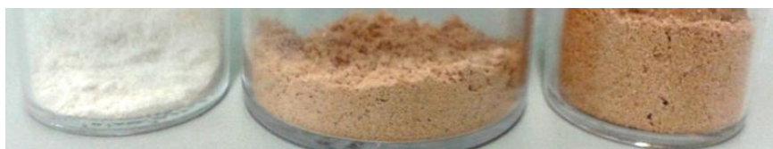
Figura 27 – Fotos dos pós de titanato de bário calcinados na temperatura de 700°C, sem \text{CeO}_2 e com 1% e 5% de \text{CeO}_2
