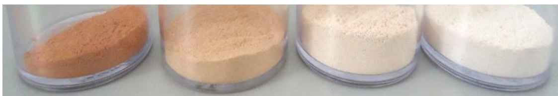
Legenda: da esquerda para a direita, amostras calcinadas a: 800°C, 700°C, 630°C e 600°C. Fonte: O autor, 2014.
