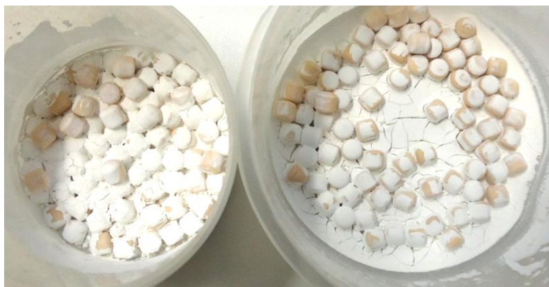
Figura 4 – Mistura seca agregada ao corpo moedor e ao recipiente
