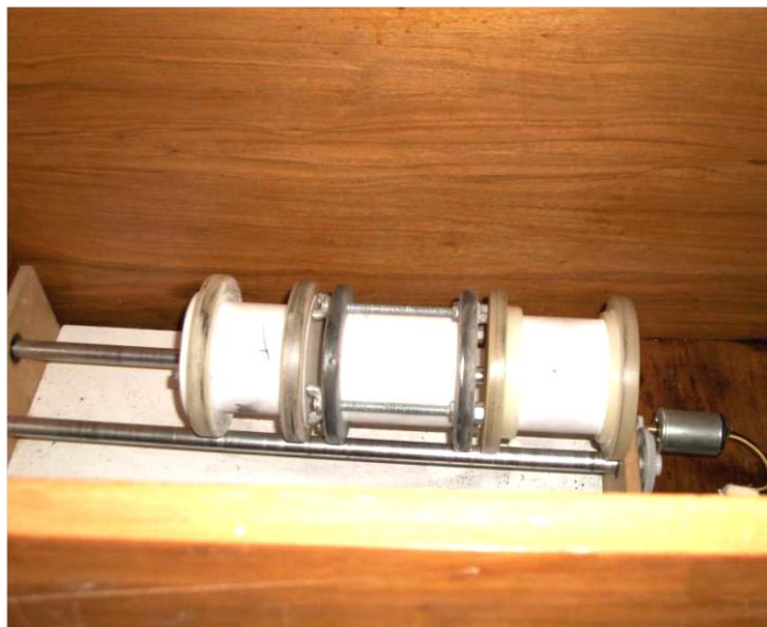
Figura 3 – Moinho de bolas com recipientes de teflon utilizados na moagem
