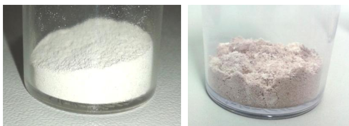
Figura 22 – Pó de titanato de bário, sem dióxido de cério, calcinado a 800°C (amostra antiga)
