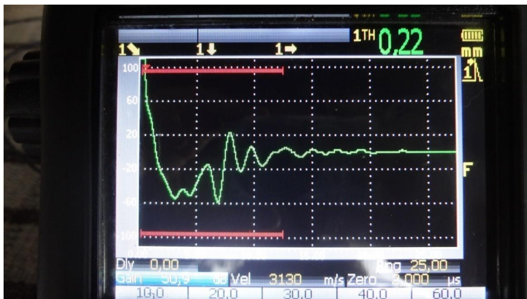
Figura 32 - Sinal RF obtido no ponto sem delaminação
