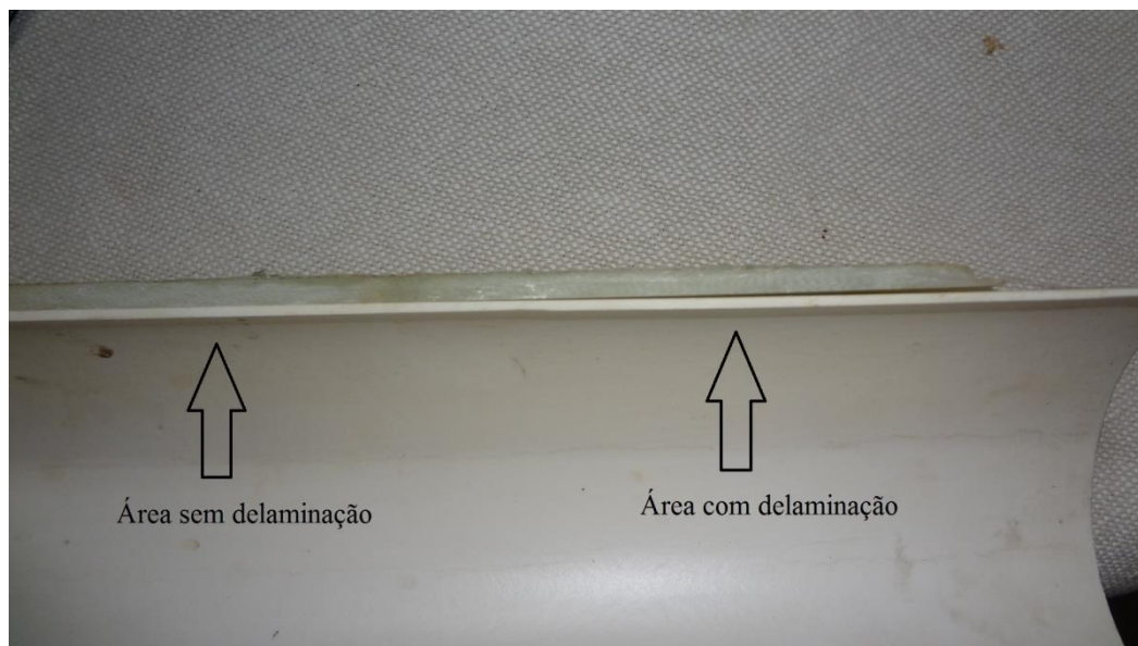
Figura 30 - Corpo de prova de PVC laminado com material compósito
