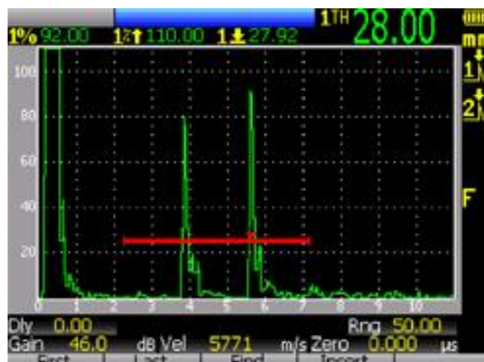
Figura 13 - Representação do A-scan
