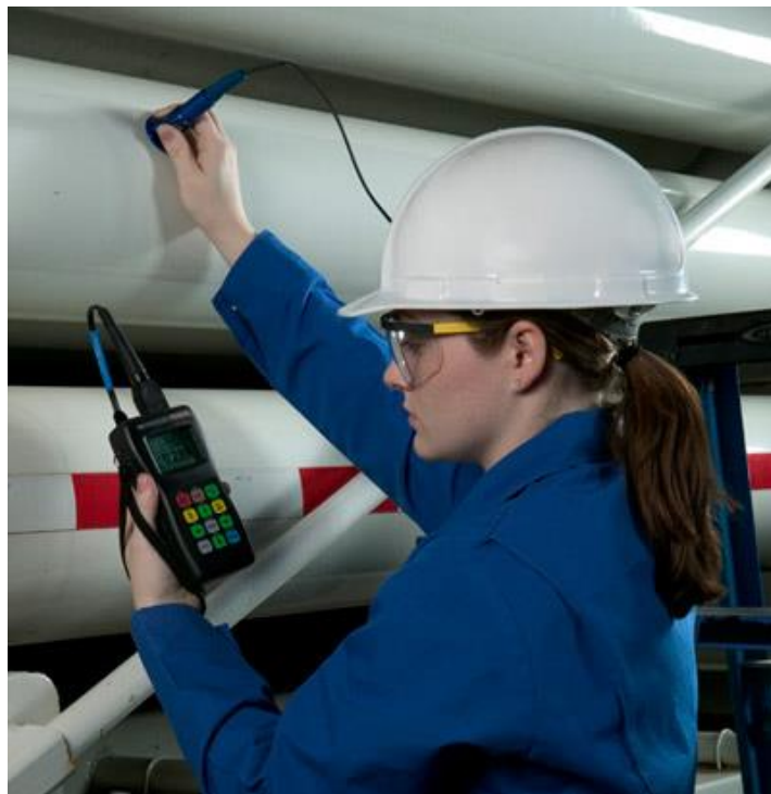
Figura 3 - Medição de espessura por ultrassom
