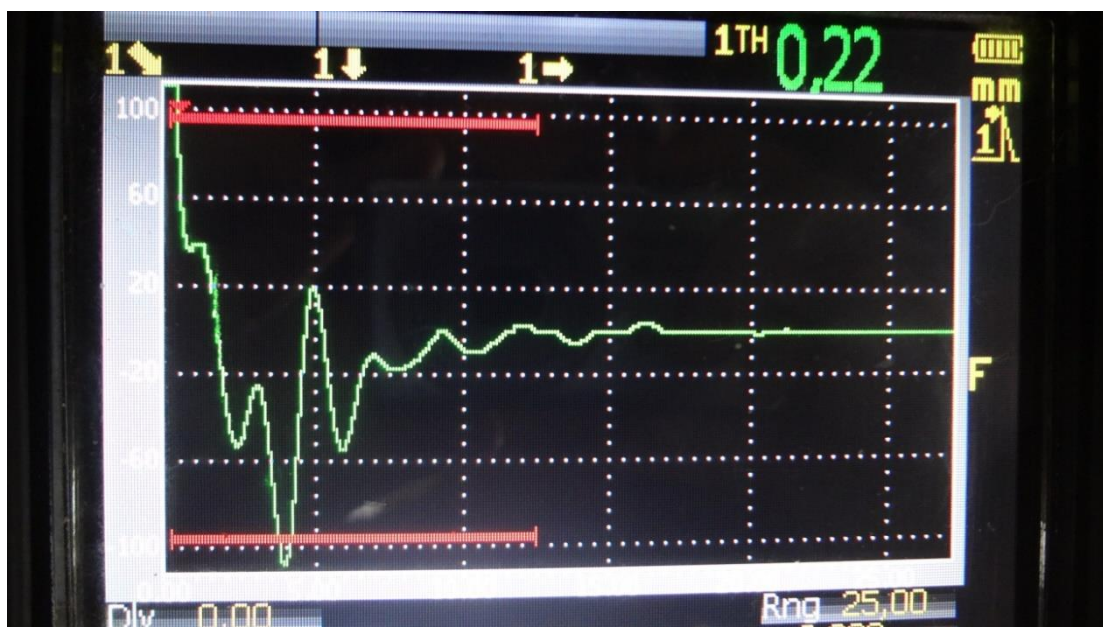
Figura 31 - Sinal no modo de Rádio Frequência (RF) obtido no ponto com delaminação
