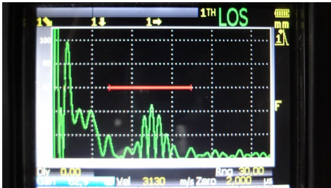
Figura 34 - Sinal com onda retificada do trecho limítrofe da perda de espessura
