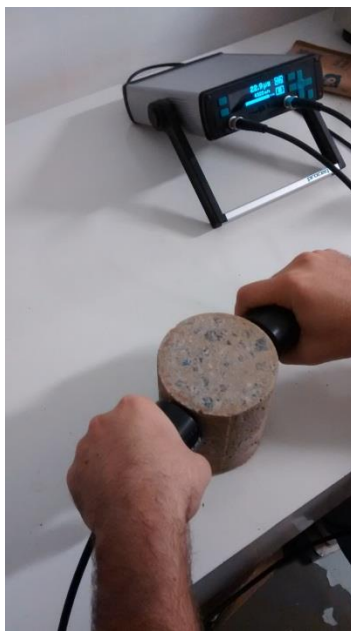
Figura 35 - Aparelho de ultrassom, transdutores e configuração de ensaio utilizados
