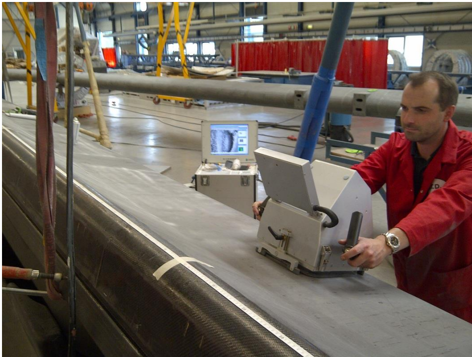
Figura 6 - Inspeção por shearografia
