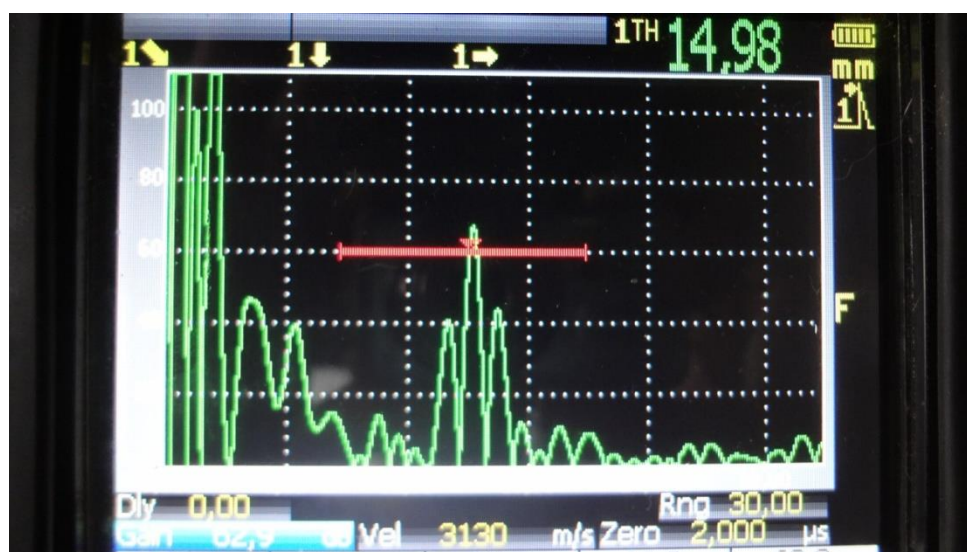
Figura 33 - Sinal de onda retificada do trecho sem perda de espessura
