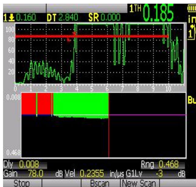
Figura 14 - Representação do B-scan
