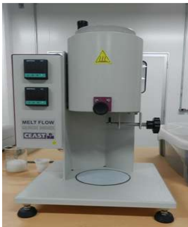
Figura 25 – Plastômetro de extrusão utilizado na determinação do MFI.
