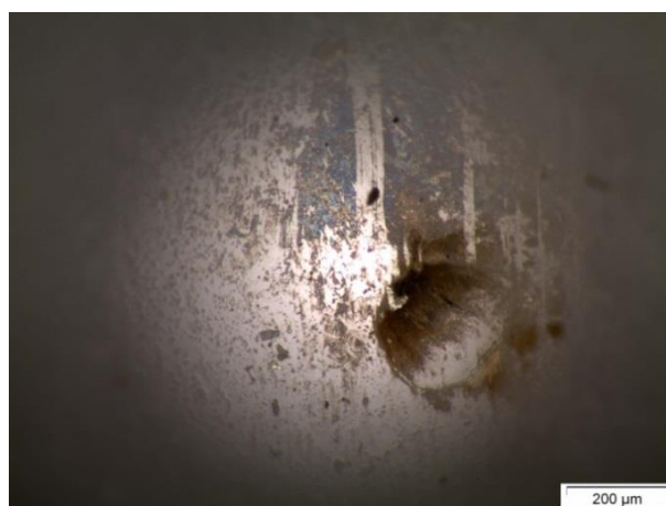
Figura 3.7 – Contracorpo utilizado no ensaio de potencial de circuito aberto para o aço AISI 304L
