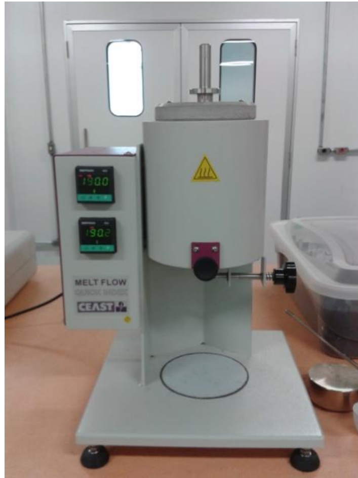
Figura 13: Medidor de índice de fluidez (MFI) usado nesta Dissertação
