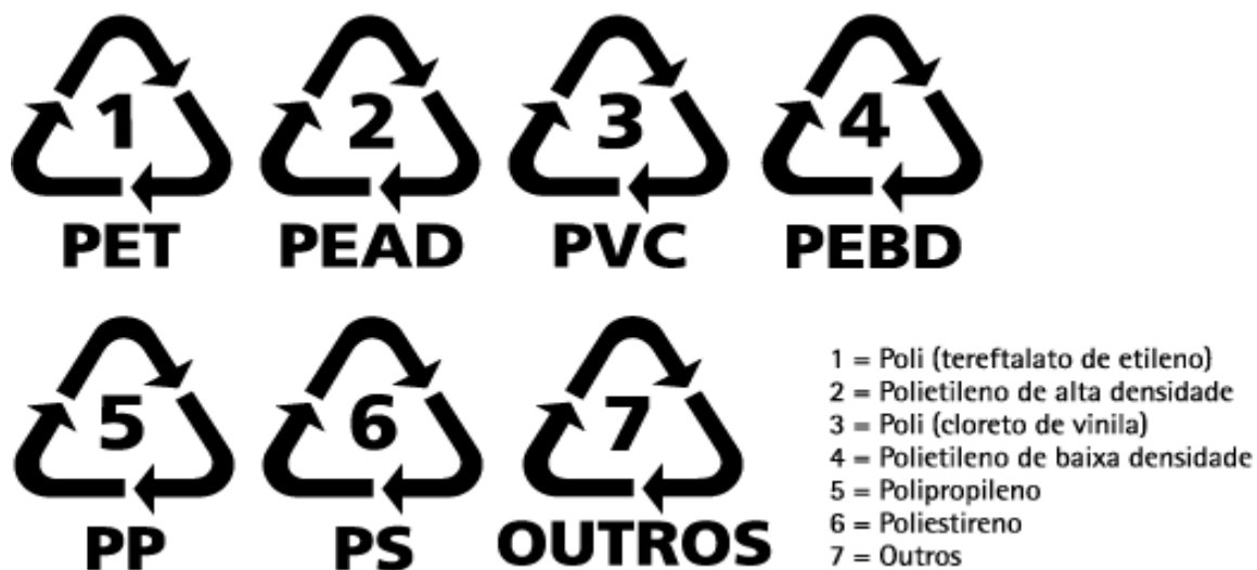
Figura 5 – Simbologia empregada pelas empresas para diferenciar os tipos de plásticos utilizados na produção de embalagens
