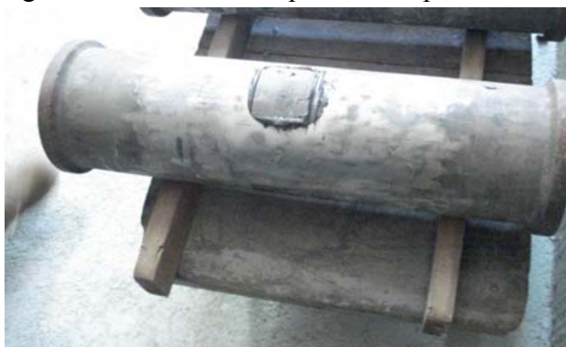
Figura 52 – Tubo com reparo de chapa colada
