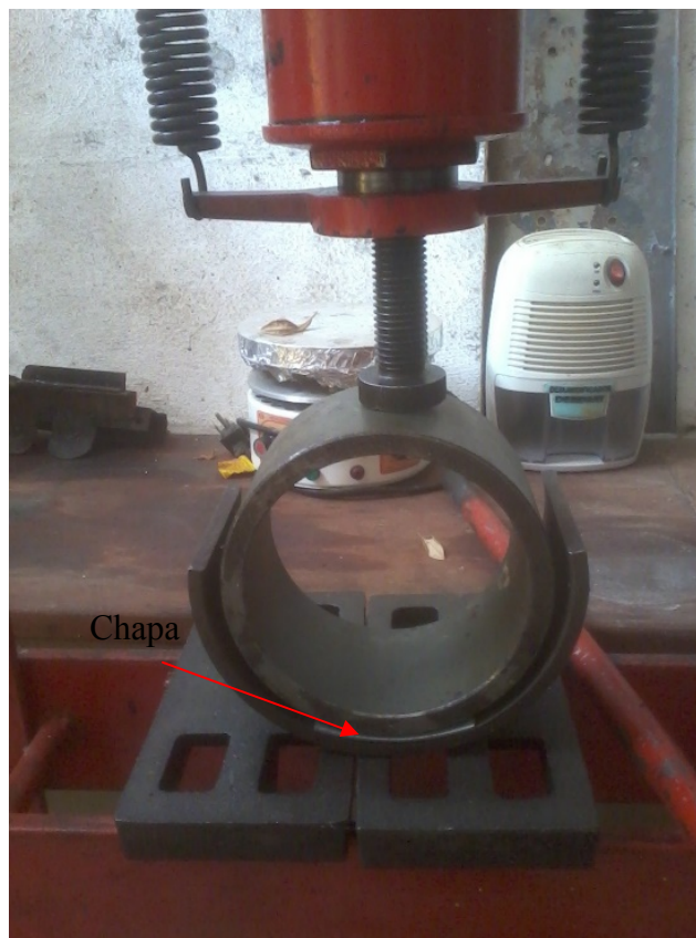
Figura 39 – Prensa utilizada para calandrar as chapas
