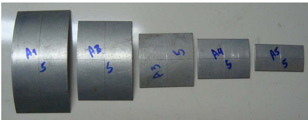
Figura 41 – Chapas calandradas com dimensão constante na direção L do tubo
