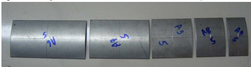
Figura 42 – Chapas calandradas com dimensão constante na direção C do tubo
