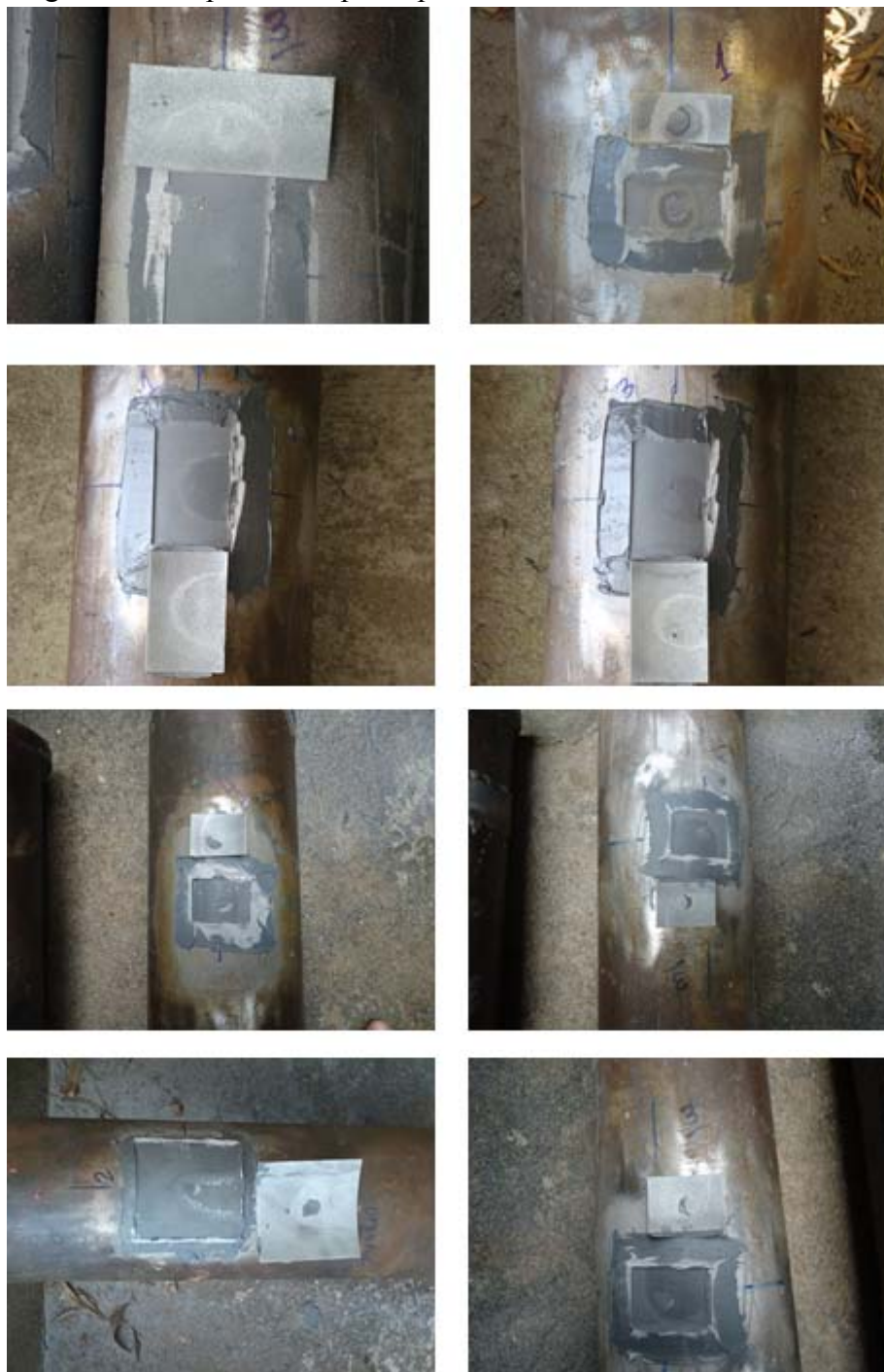
Figura 60 – Ruptura do reparo após ensaio hidrostático
