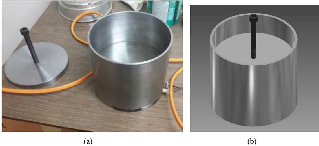
Legenda: (a) – Equipamento montado com a resistência elétrica; (b) – Comparação com o modelo em CAD.
