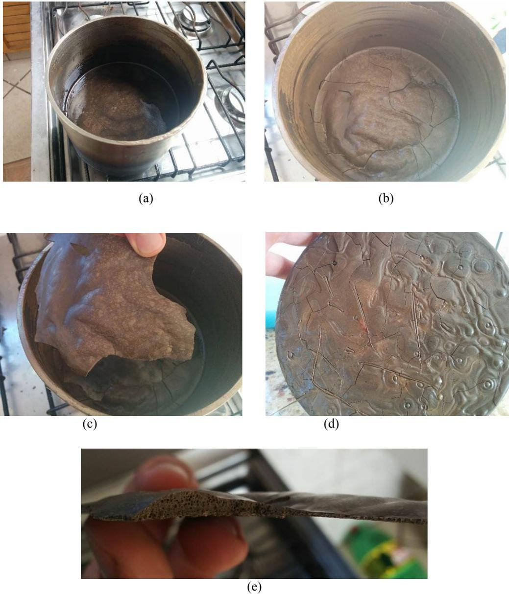
Legenda: (a) – Massa ainda líquida sob resfriamento a temperatura ambiente; (b) – Massa de tecido após resfriada; (c - d) – Placas produzidas; (e) - Espessura das placas produzidas.
