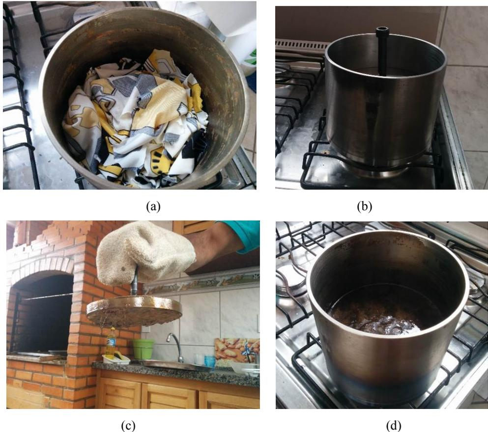
Legenda: (a) – Tecido (Microfibra) colocado no equipamento; (b) – Equipamento durante aquecimento com tampa; (c) – Retirada da tampa após derretimento do tecido; (d) – Massa derretida no equipamento.
