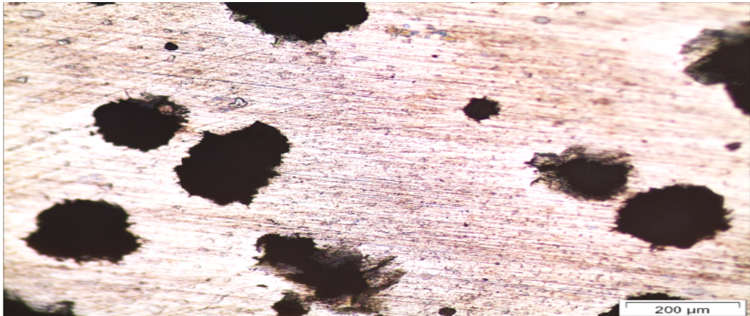
Figura 3.7 - Pite no aço martensítico (3M)
