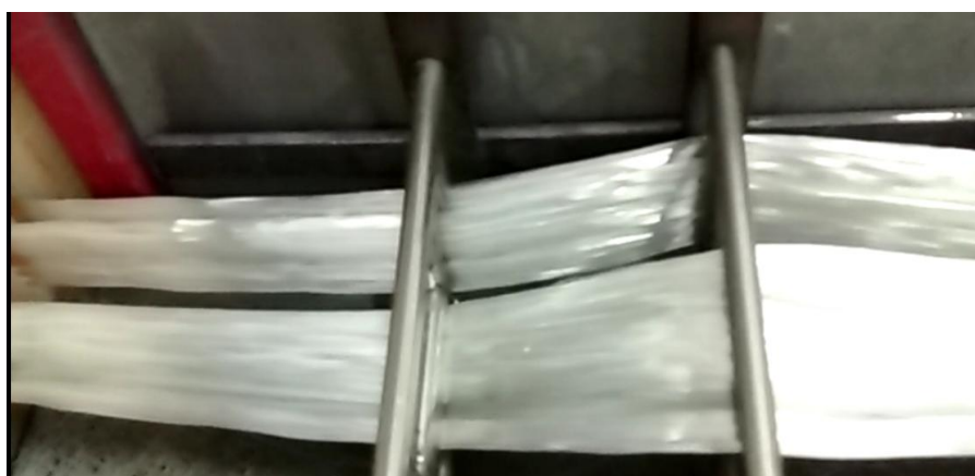
Figura 17 – Vista superior da banheira aberta: Fibras tracionadas e espaçadas
