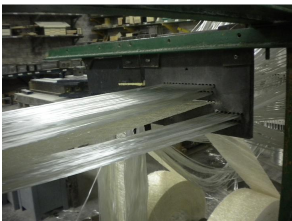
Figura 15 – Alinhamento das pontas e da manta na placa de introdução
