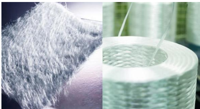
Figura 33 – Material de reforço: manta de vidro contínua e rovings
