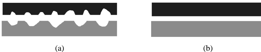
Figura 13 - Esquema de superfícies: a) Superfície porosa b) Superfície lisa
