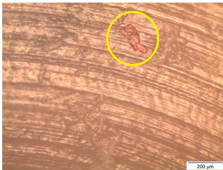
Figura 56 - Microscopia Óptica do PEAPM com 1% vitamina C e dose de 50 kGy
