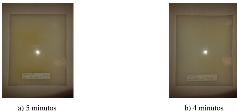
Figura 29 - PEAPM prensado a 160° C com 2% Vitamina C em tempos variáveis
