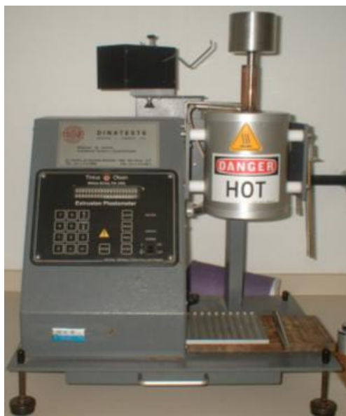
Figura 3.5 – Equipamento utilizado para determinação do índice de fluidez das misturas. Fonte: Laboratório Tecpol – IPRJ.
