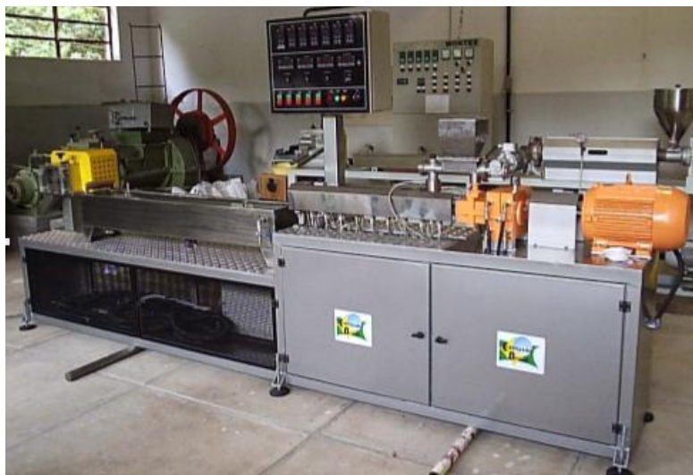
Figura 3.1 – Extrusora de rosca dupla – Modelo DRC 22D . Fonte: Laboratório Tecpol –IPRJ.
