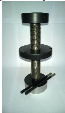
Figura 19 - O pistão/êmbolo do novo reator
