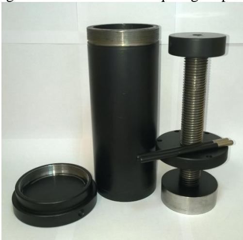
Figura 20 - O reator de briquetagem por batelada hermética - versão 2016
