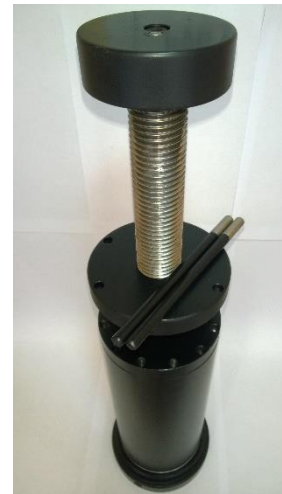
Figura 20 - O reator de briquetagem por batelada hermética - versão 2016
