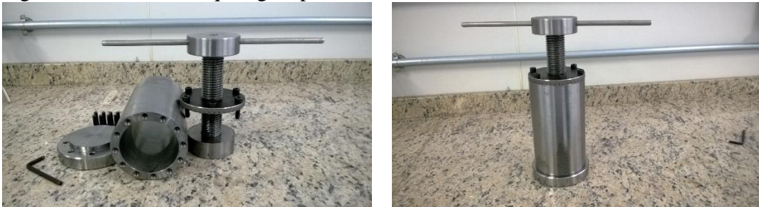
Figura 3 - Reator de briquetagem por batelada hermética - versão 2014
