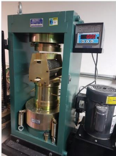
Figura 16 – Máquina de ensaio com dispositivo auxiliar de compressão diametral
