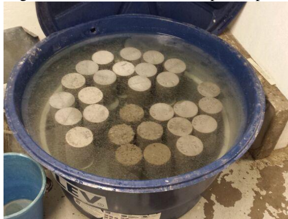
Figura 14 – Cura úmida dos corpos de prova
