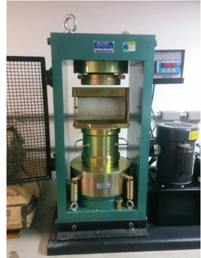
Figura 16 – Máquina de ensaio com dispositivo auxiliar de compressão diametral
