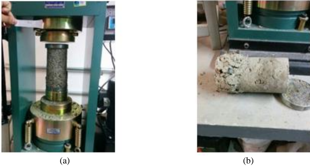
Figura 20 – Corpo de prova após ensaio de resistência à compressão
