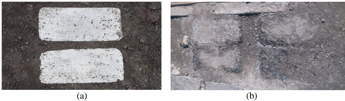
Figura 21 – Placas de concreto após serem submetidas a carregamento variável
