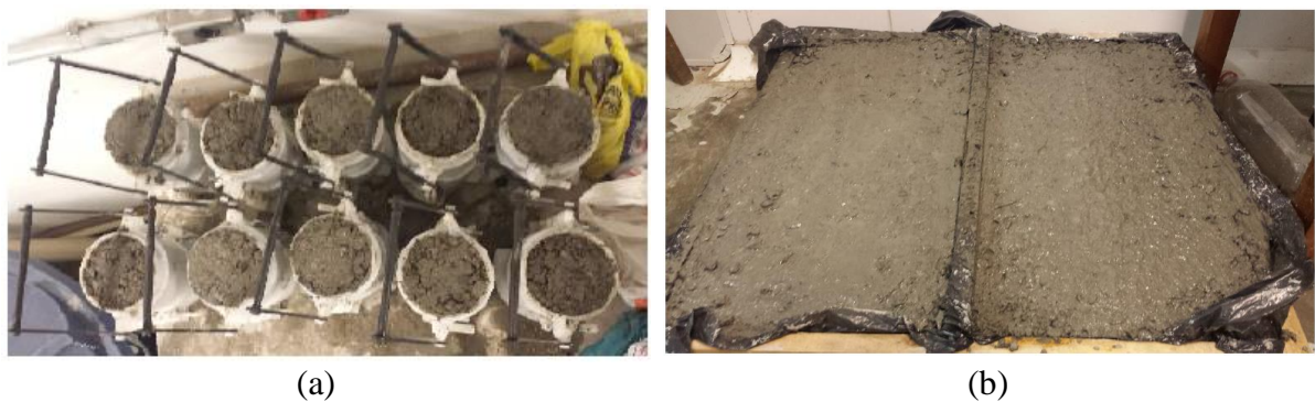
Figura 12 – Moldagem dos corpos de prova
