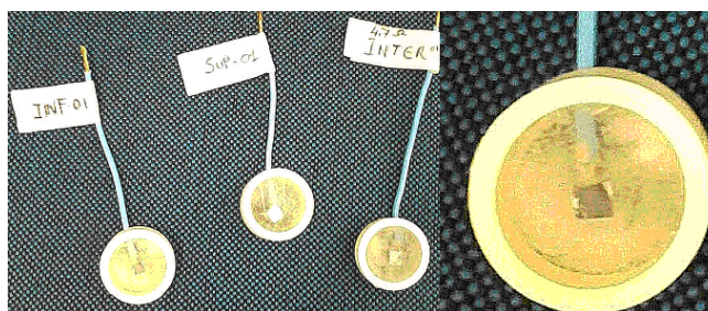
Figura 40 - Corpos de prova confeccionados para o ensaio de corrosão
