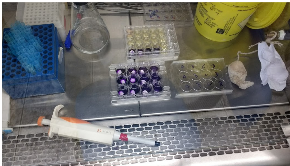
Figura 4 - Placas com os discos e a solução de cristal violeta 0,1% nos poços
