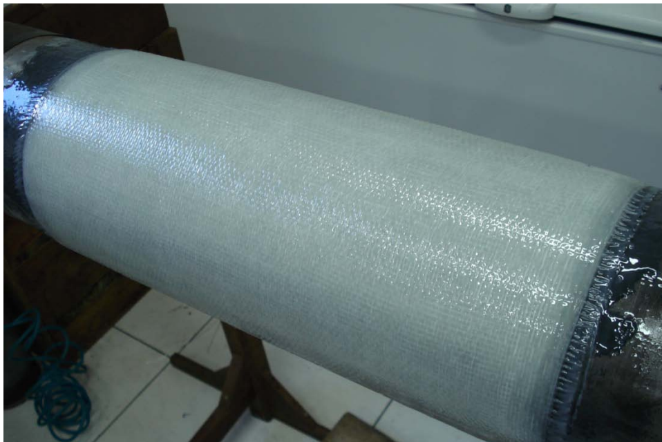
Figura 5.17: Aspecto final do cp feito à partir do processo de laminação manual
