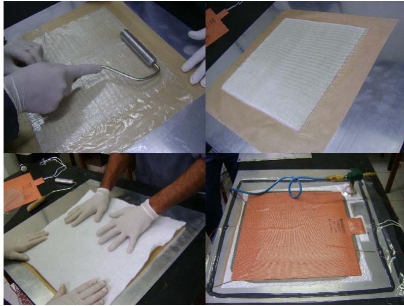
Figura 5.7: Preparo da placa para confecção dos cp's de tração
