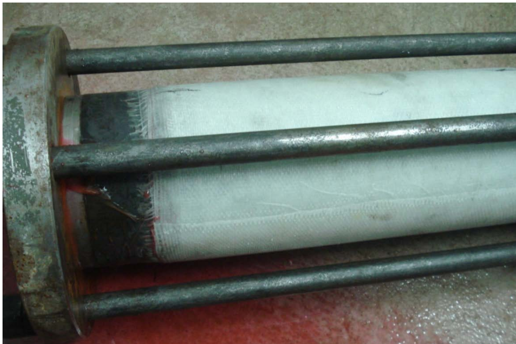
Figura 6.9: Falha por delaminação
