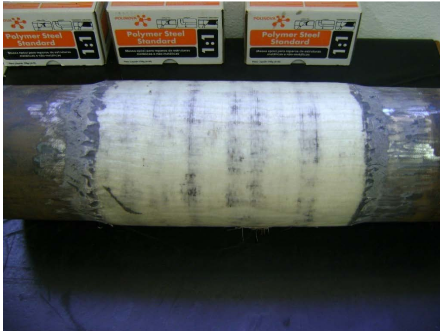
Figura 5.10: Corpo de prova com tecido pré-impregnado
