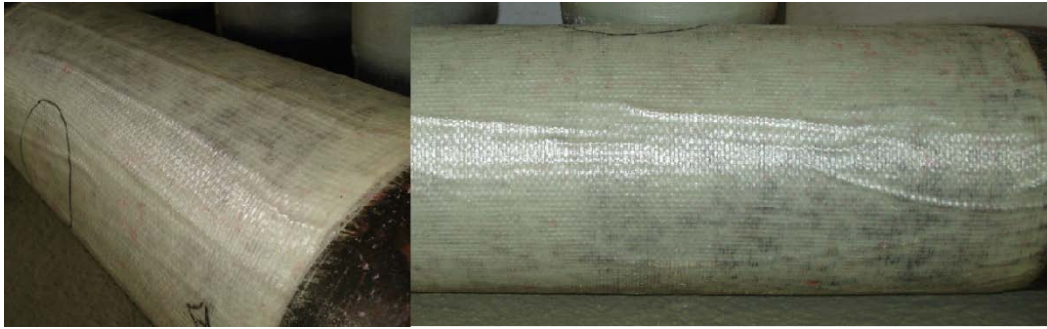
Figura 5.14: Rugas provocadas pela aplicação de vácuo
