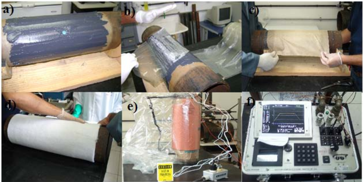
Figura 5.9: Preparo do corpo de prova para teste hidrostático (pré-preg)
