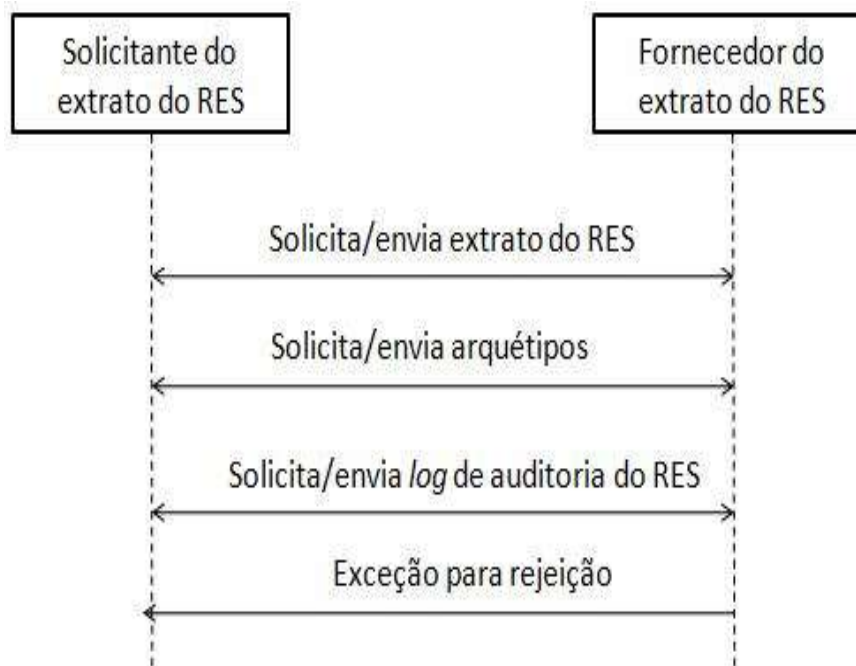
Figura 7 - Diagrama de interação da norma ISO 13606 Fonte: ISO 13606-5, 2010.
