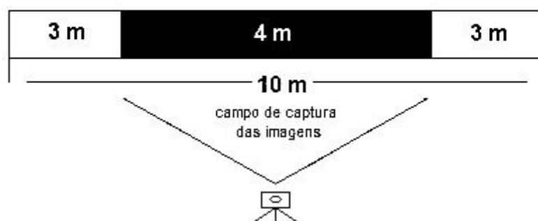
Figura 12 – Pista de marcha com 10 metros de extensão. Distância intermediária de 4 metros para coleta dos dados (faixa escura). Câmera posicionada ortogonalmente à pista. Seis metros separam a câmera da pista.
