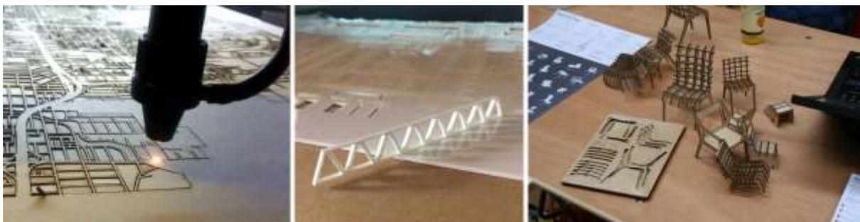
**Legenda:** Imagens ilustrativas de uma de corte a laser CNC em funcionamento, as peças por ela geradas e seus produtos finais montados.
