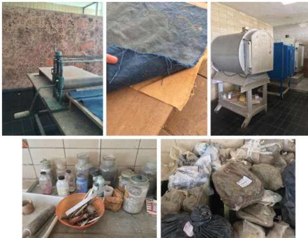
**Legenda:** Imagens diversas da oficina de cerâmica da FAU-UFRJ: a prensa, as lonas para proteção do barro prensado, os fornos, esmaltes em pó e instrumentos, e o barro armazenado.
