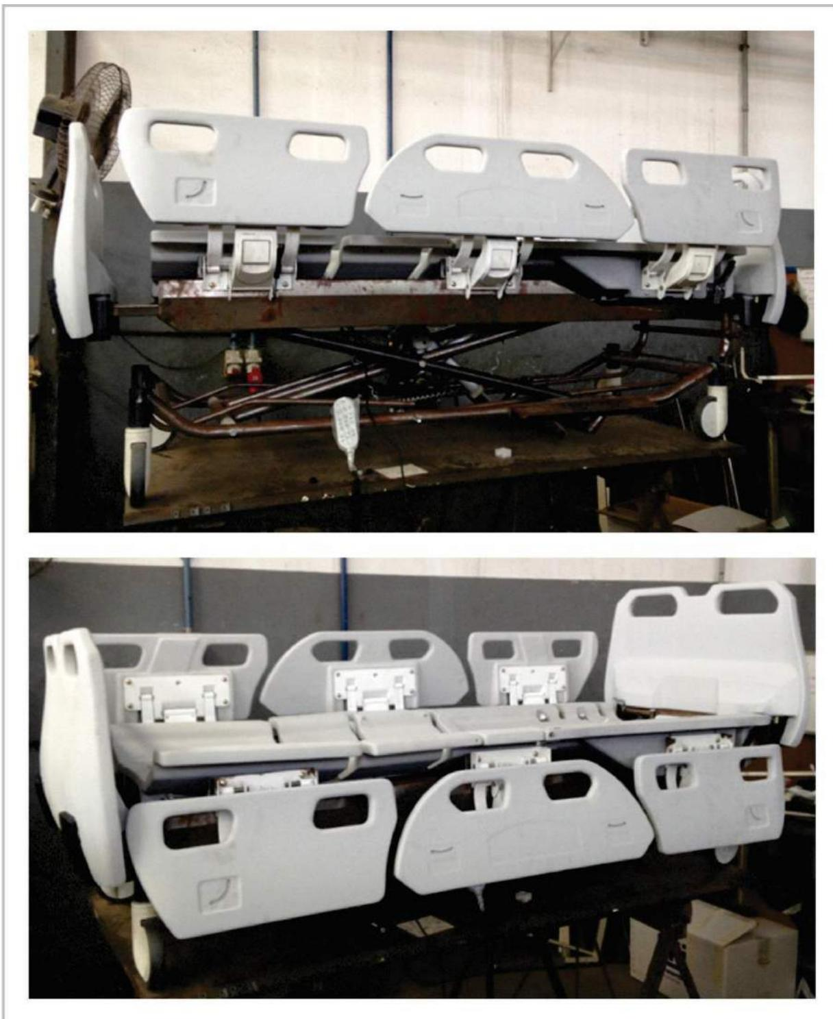
Figura 102: *Mockup 02* – Modelo escala 1:1, finalizado e pronto para avaliações.
