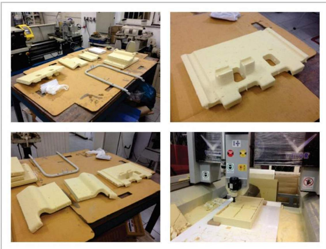
Figura 132: Produção dos modelos físicos das peças que compõem as superfícies do leito e de outros elementos estruturais, em poliuretano expandido e usinados em fresadora CNC.
