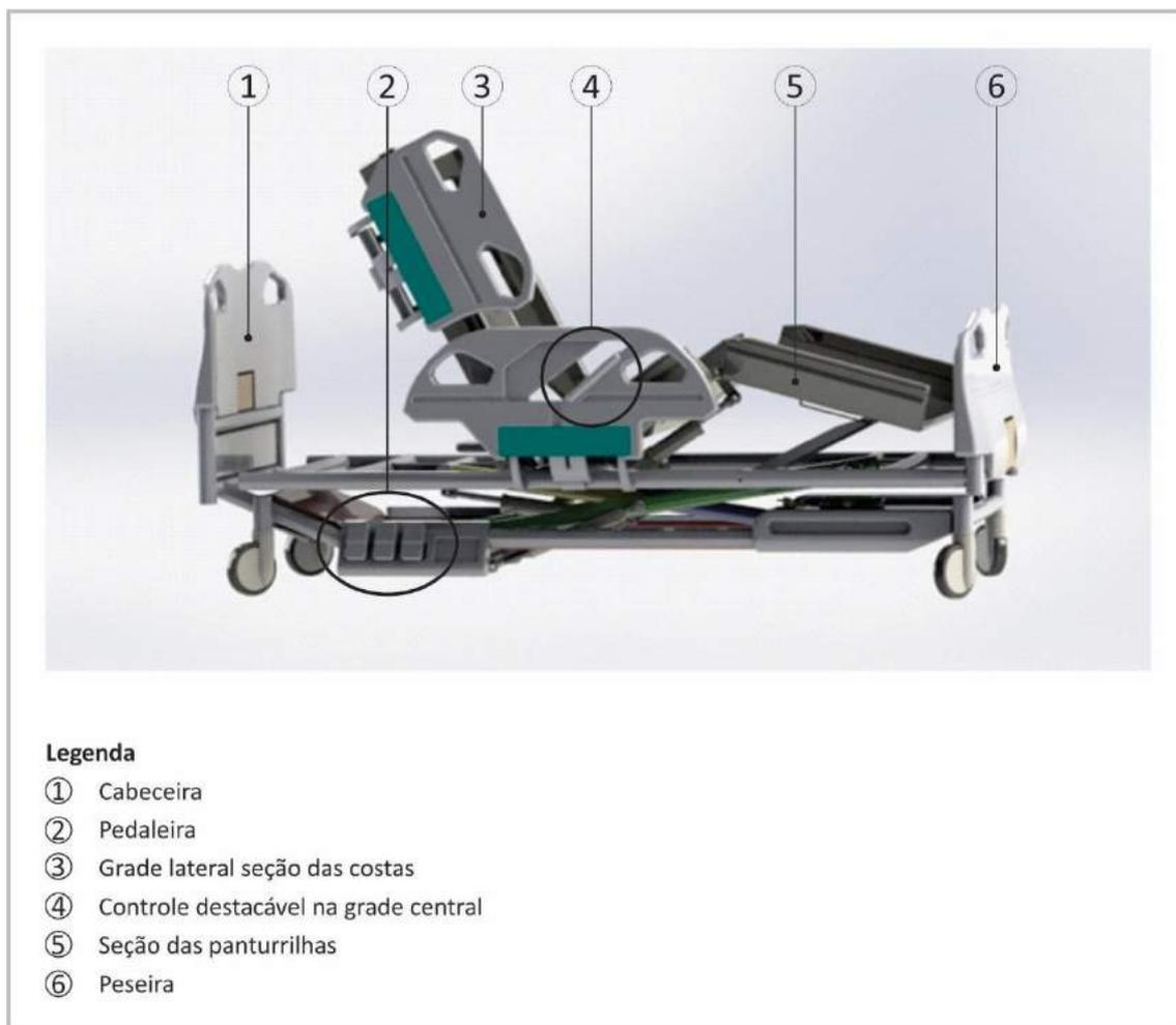
Figura 79: Redesenho com ajustes do modelo das grades e proposição de posicionamento do controle destacável do paciente na grade lateral central da localização das peseiras laterais de controle na seção do carro.
