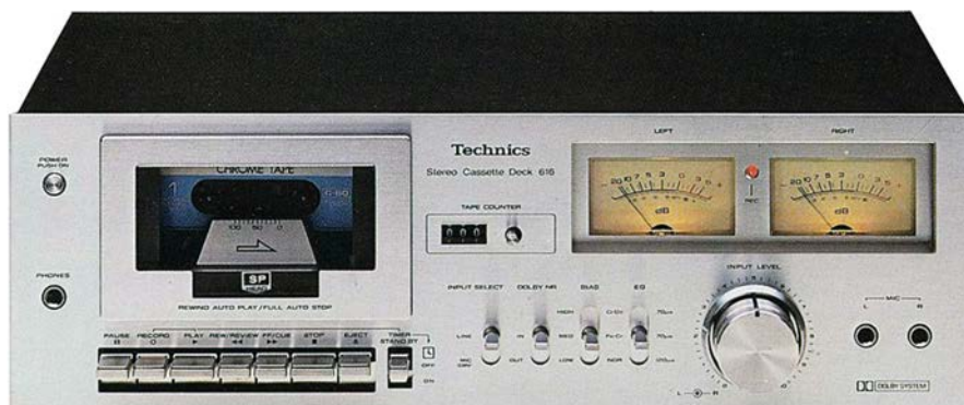
Figura 40 — Botões da interface do toca-fitas
