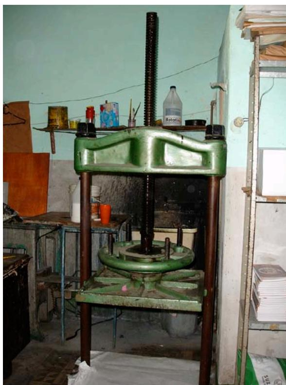
Figura 59: Prensadeira. (Fonte: Nitpress)
