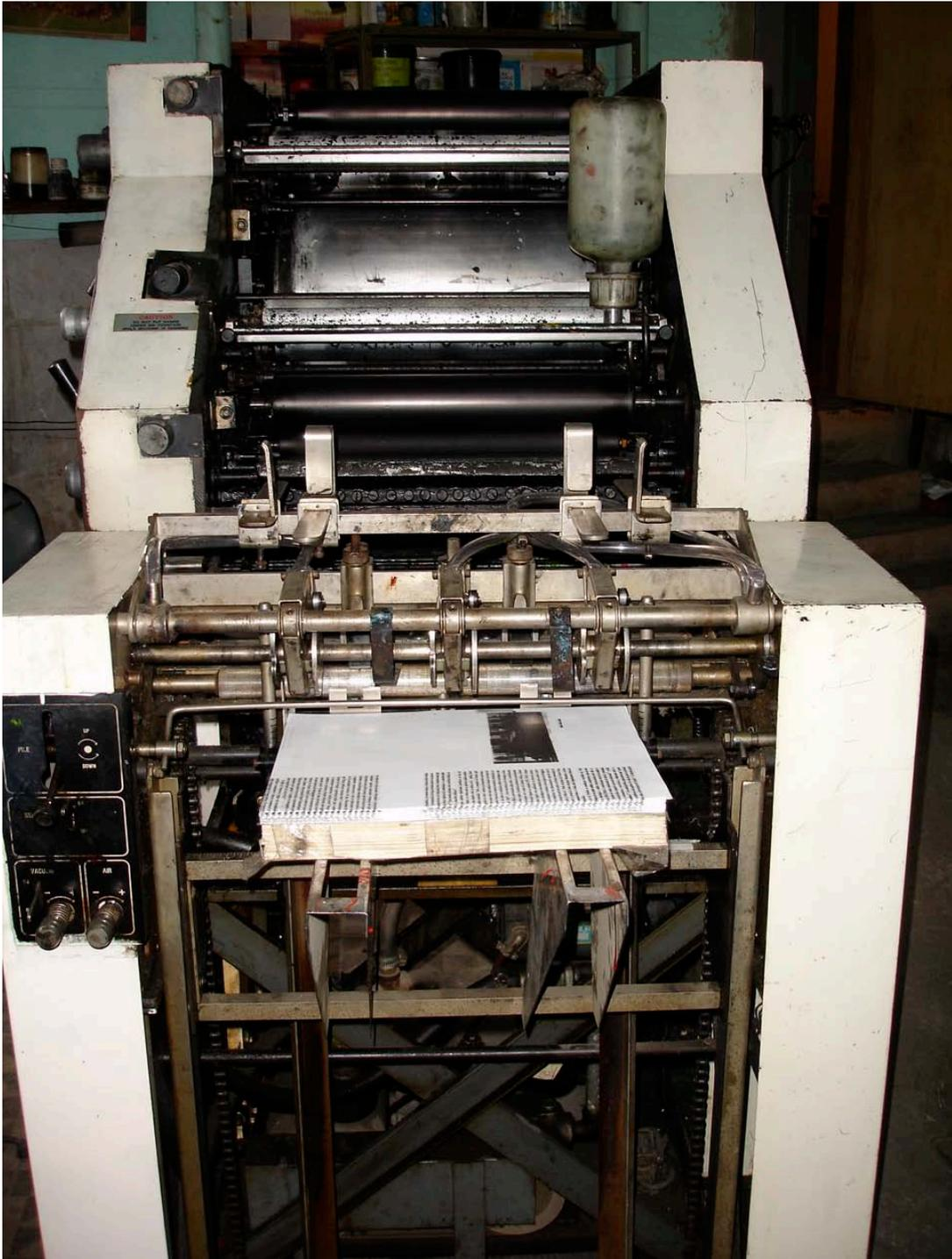
Figura 55: Impressora ofsete. (Fonte: Nitpress)
