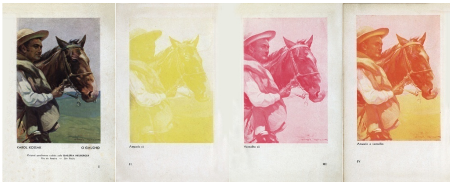
Figura 54 – Exemplo de seleção de cores: policromia, amarelo, magenta e amarelo+magenta (Fonte: ASV).
