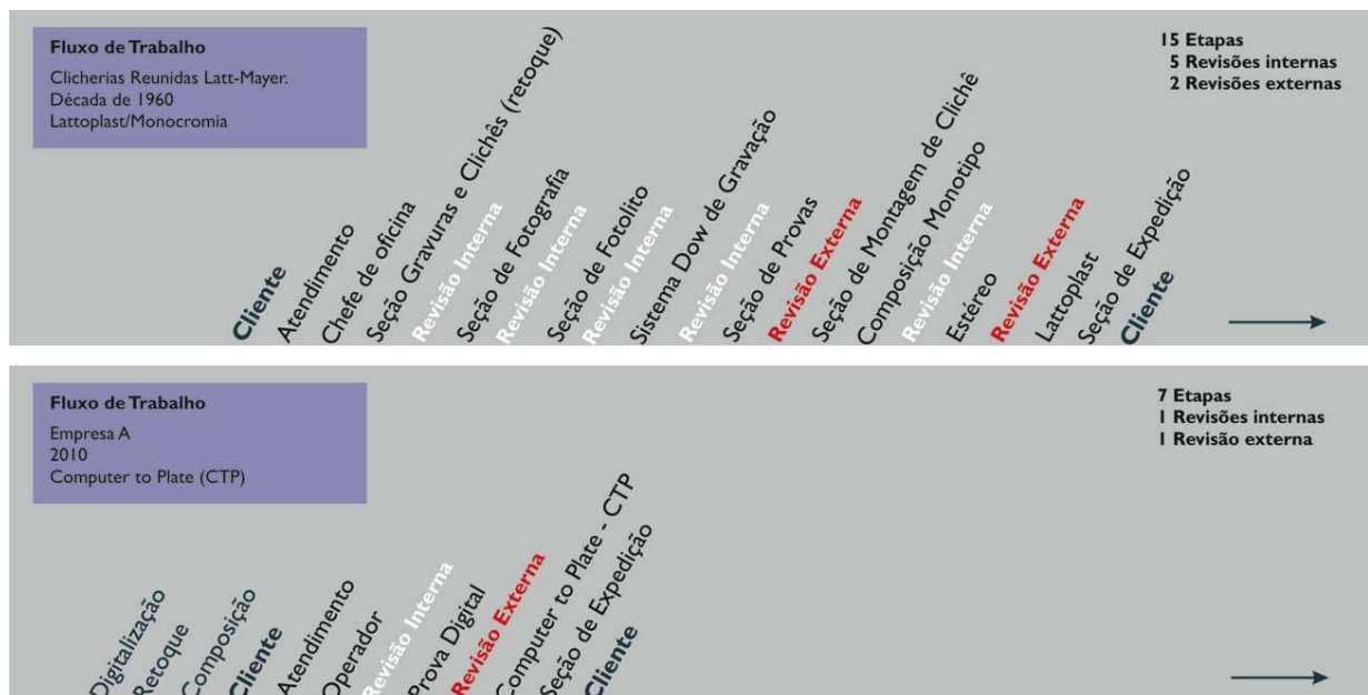
Figura 106—Exemplos de fluxos de trabalho para produção de matrizes de Lattoplast e CTP.
