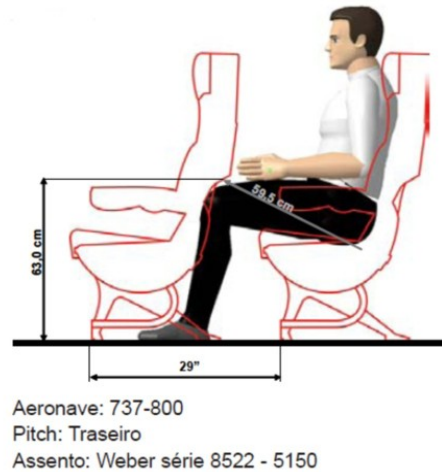
Figura 52: B737-800 da GOL - poltrona com pitch 29" (736,6 mm) e espaço útil de 595 mm Fonte: "Projeto Conhecer" (SILVA E MONTEIRO, 2009), pág. 30
