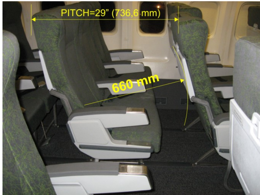
Figura 79: poltrona Weber 4001 com pitch 29" (736,6 mm) e espaço útil de 660 mm
