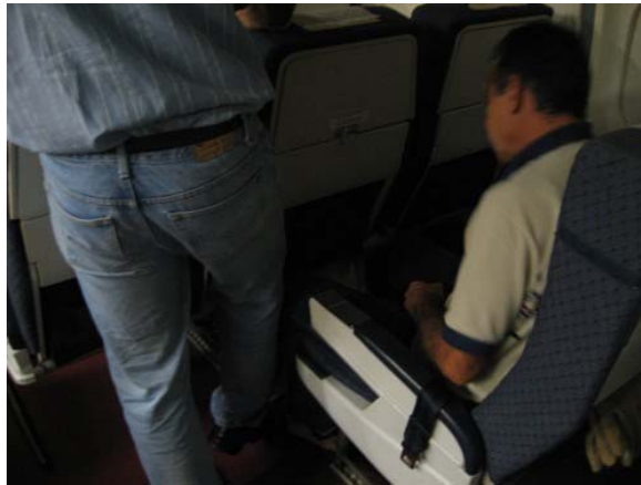
Figura 73: acesso ao assento da janela com os encostos à frente reclinados e o assento do corredor ocupado
