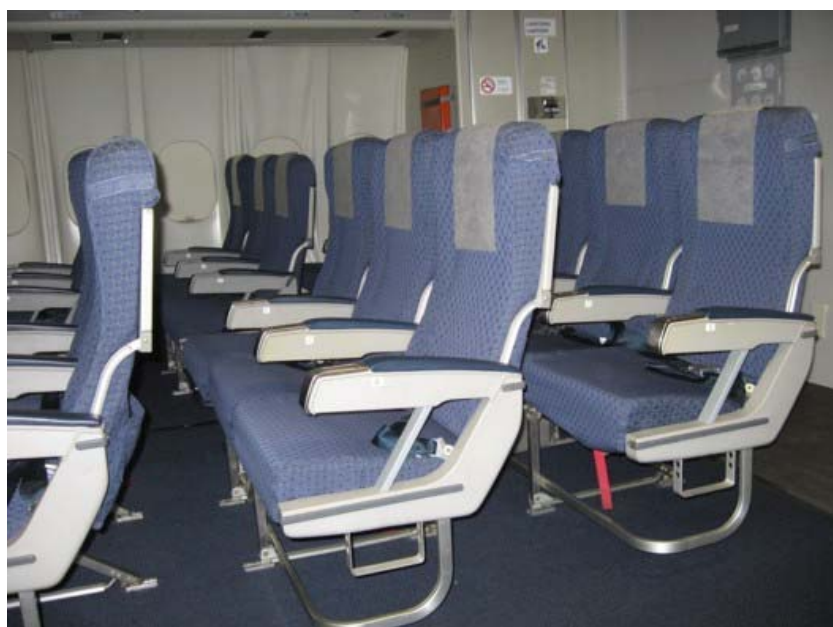
Figura 58: poltrona Koito , mod. ARS-427, típica da classe econômica dos aviões comerciais
