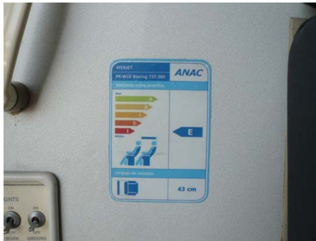
Figura 81: placar obrigatório com a indicação da classificação do avião no programa dimensional ANAC
