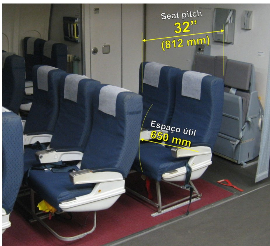
Figura 70: espaçamento entre poltronas Weber p/n 820252-417, típicas long haul usadas no B737-200 da antiga Varig
