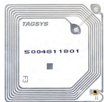
Figura 14. Exemplo de etiqueta de identificação por rádio-frequência, mostrado aqui em tamanho real
